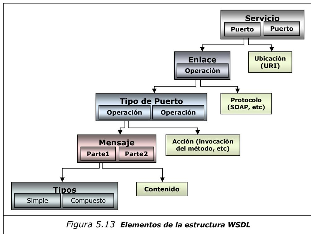
La estructura del WSDL define seis elementos: [WWW 023]
