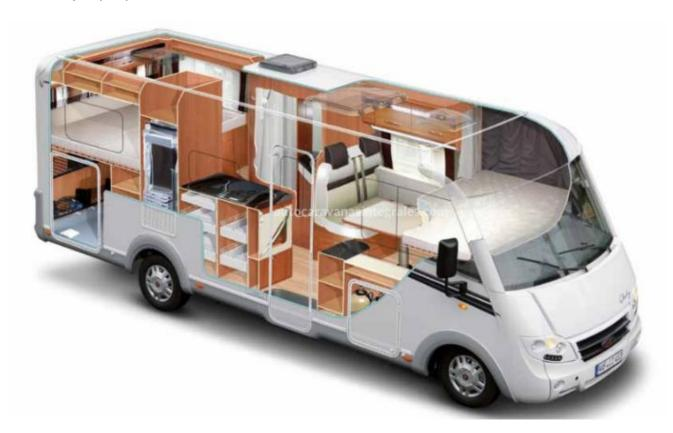
*Nota.* Diseño con el croquis que puede tener el interior de un vehículo modificado para ser casa rodante. Tomado de autocaravanasintegrales y lalbacaravaning
