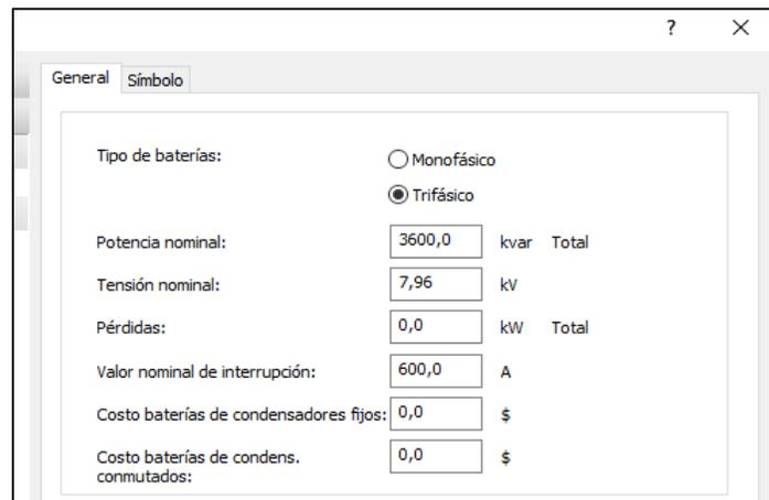
Fig. 23 Parámetros del banco de condensadores
