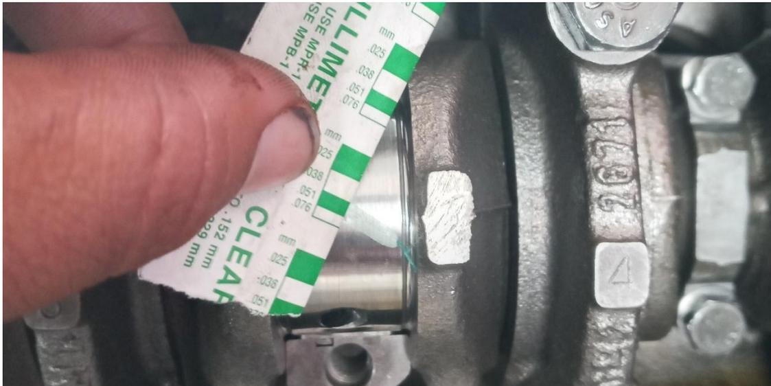
**Figura 14** Comparación de las medidas obtenidas por el plastigage
