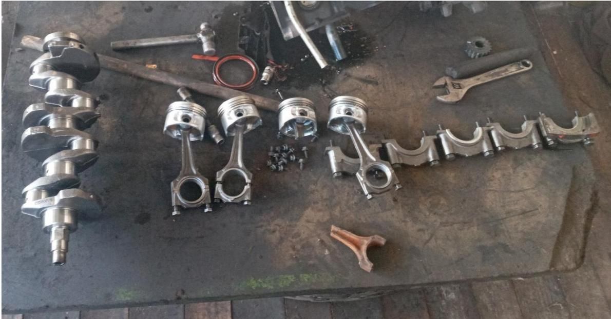
**Figura 3.2.** Piezas móviles de un motor Chevrolet corsa Wind 1400 cc.
