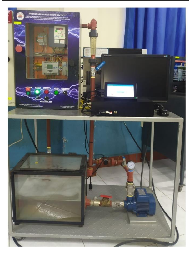
Fig. 26 . Módulo de control de caudal de líquidos., Laboratorio de Control
