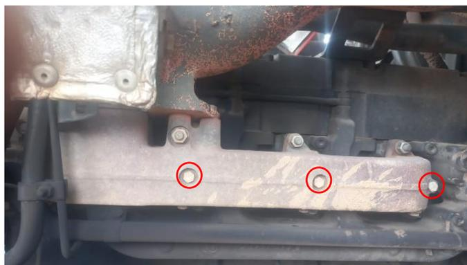
**Figura 2.4** Tapones del colector de escape cilindro 2,3 y 4
