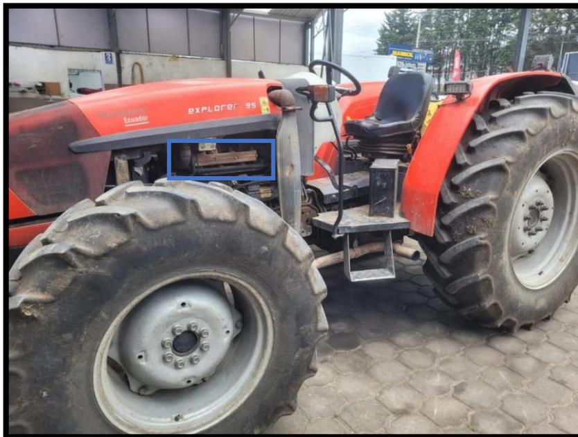
**Figura 2.3** Ubicación del colector de escape en el tractor
