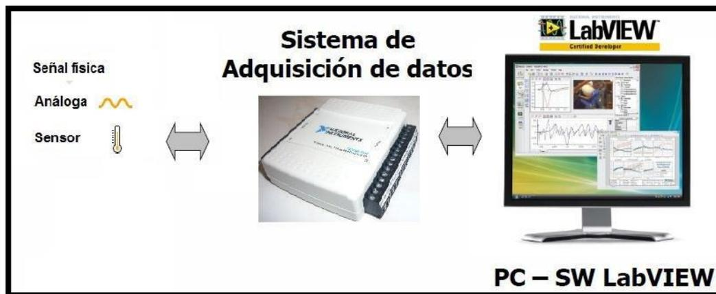
**Figura 1.4** Sistema de adquisición de datos
