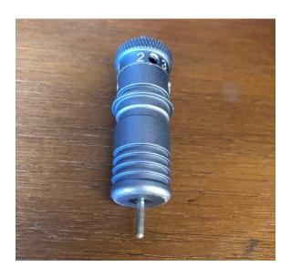
Después de contar con el punzón, este se posiciona junto al solenoide (Ver Figura 3.41), sujetándose bien en la estructura y asegurando su distancia por encima del papel.
