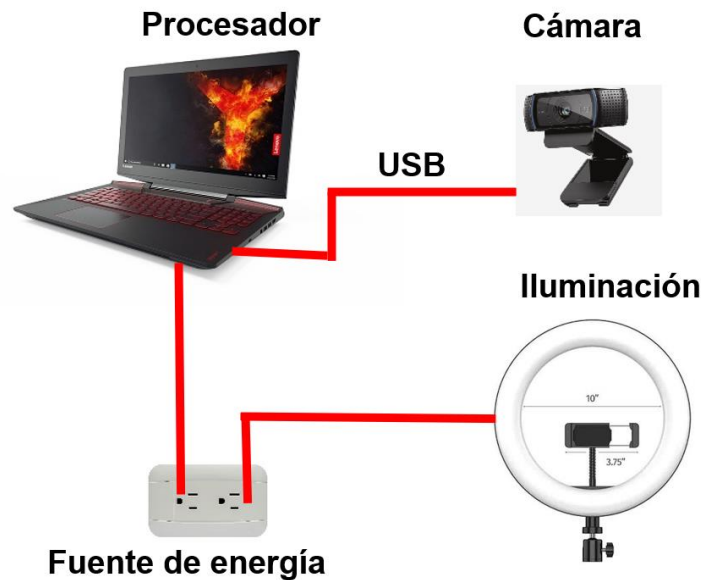
Figura 32 Diagrama de conexión de hardware.
