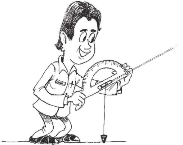
Con los materiales descritos anteriormente procedemos a montar el dispositivo de la siguiente manera: adosamos la agarradera al graduador por el borde recto en el cual vamos a insertar el puntero laser y lo fijamos utilizamos cinta adhesiva, luego con el hilo hacemos un lazo en el extremo para atar el clavo y por el otro extremo amarramos al centro del trasportador, mismo que se constituirá en una plomada, al dejar caer libremente.
