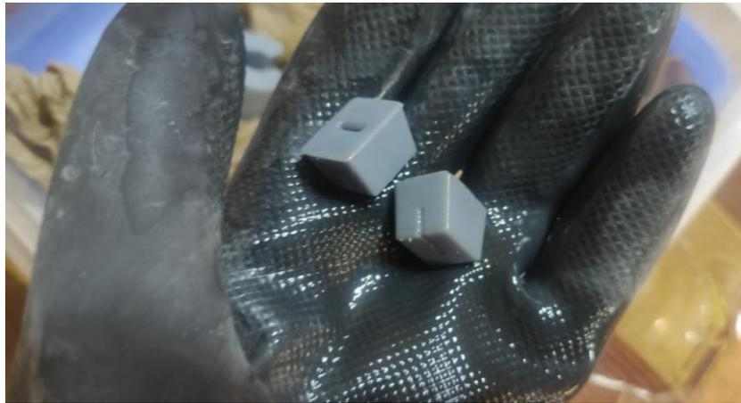
**Figura 3.40** Limpieza de impurezas post impresión de perillas
