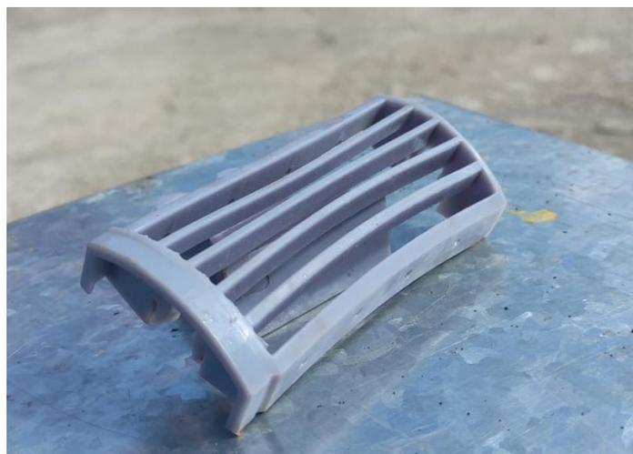
**Figura 3.31** Curado de rejilla de aire post impresión
