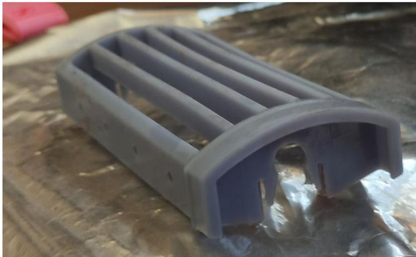
**Figura IV.5** Rejilla Impresa en Resina Uv Tough de Anycubic
