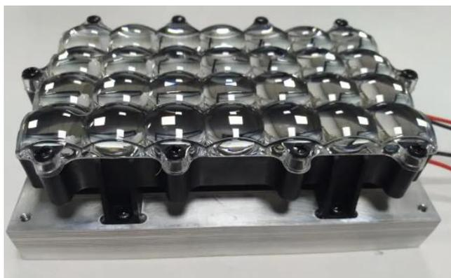
**Figura 2.10** Fuente de luz ultravioleta
