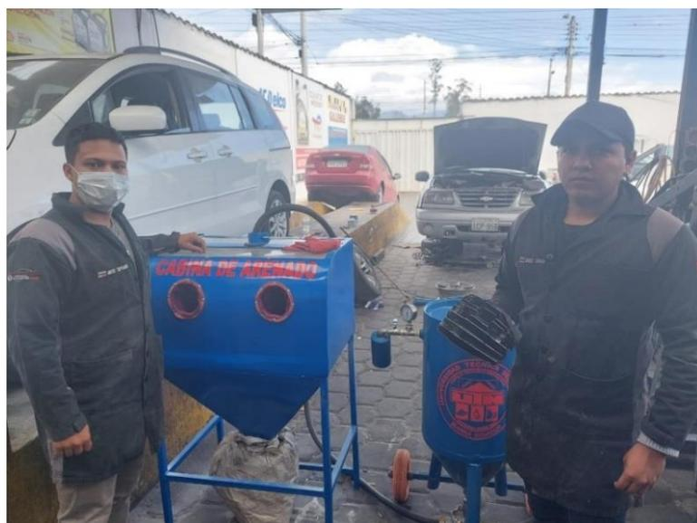
**Figura 3.36** Implementos de seguridad personal con cabina para arenado
