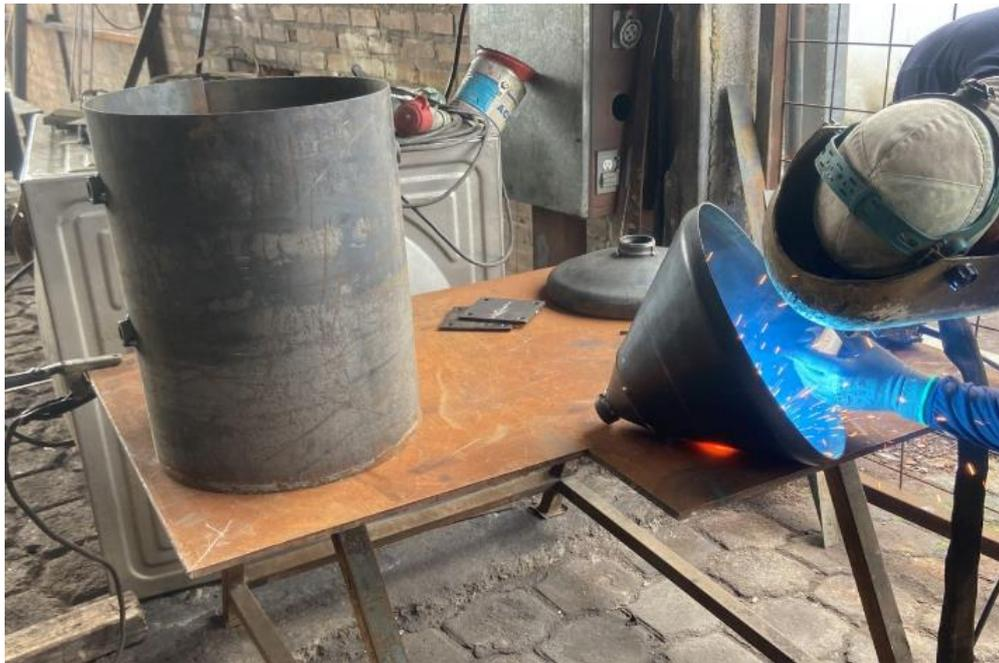
**Figura 2.15** Procesos de suelda en tolva y cilindro
