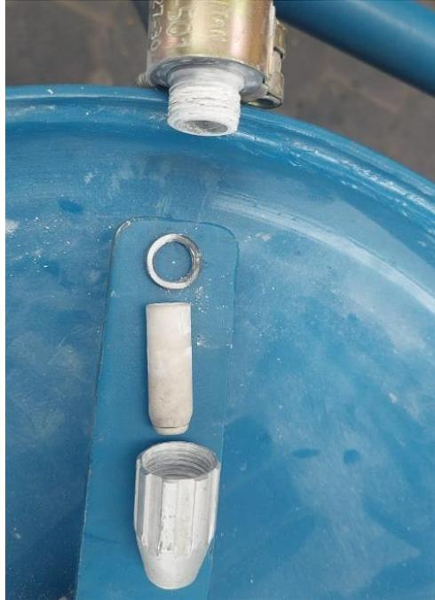
**Figura 3.39** Desmontaje de punta de máquina de limpieza por arenado
