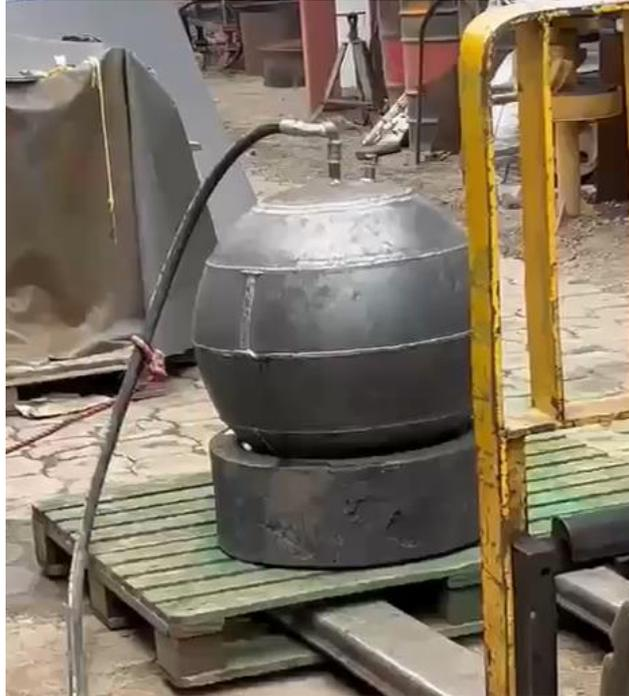
**Figura 3.6** Prueba hidrostática
