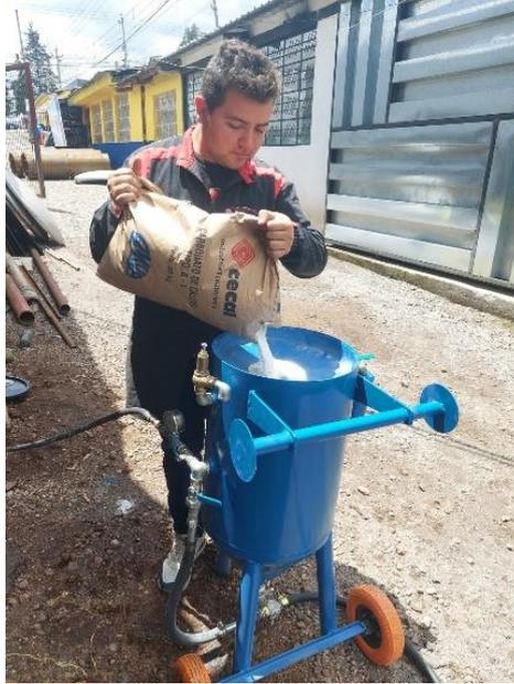
**Figura 3.26** Colocación de material abrasivo
