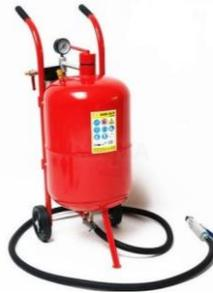
**Figura 1.5** Arenadora a presión
