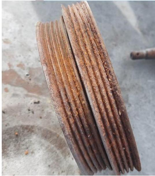
**Figura 3.49** Polea de cigüeñal antes de ser arenada
