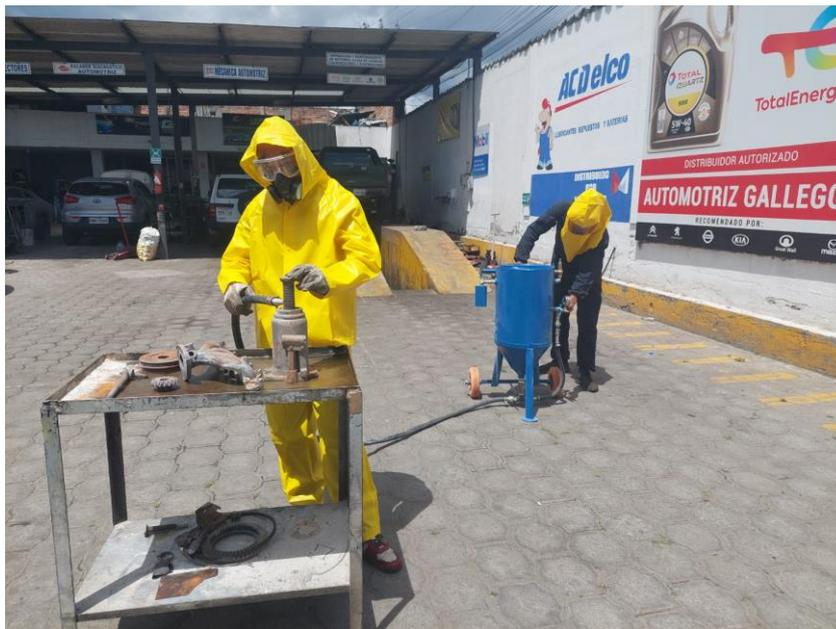
**Figura 3.29** Coordinación entre dos personas para la manipulación de máquina
