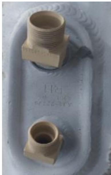
**Figura 3.56** Acoples de contenedor después de ser arenados
