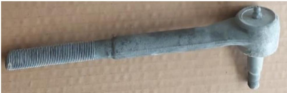
**Figura 3.64** Axial después de ser arenado
