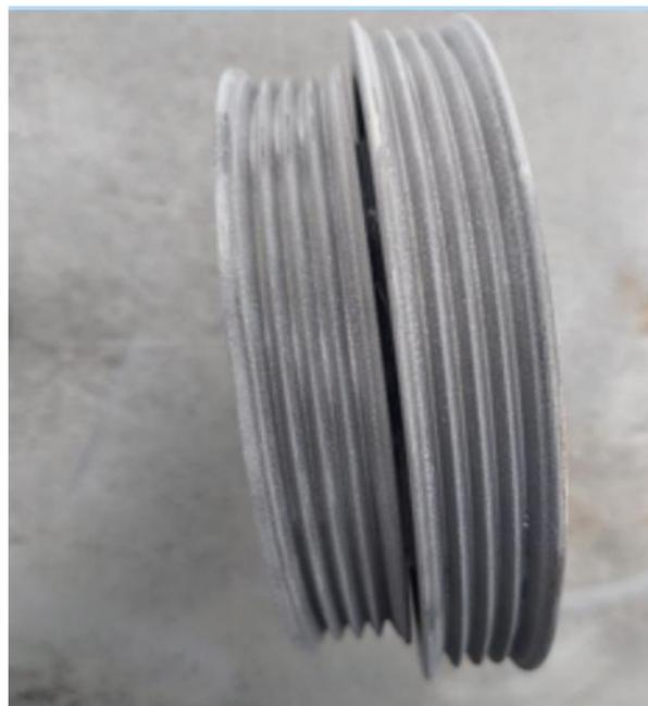
**Figura 3.50** Polea de cigüeñal después de ser arenada
