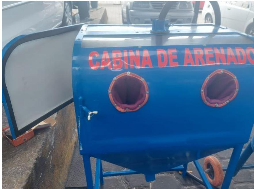
**Figura 2.23** Cabina de arenado
