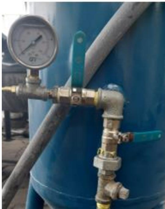
**Figura 3.28** Válvulas en la máquina de limpieza por arenado
