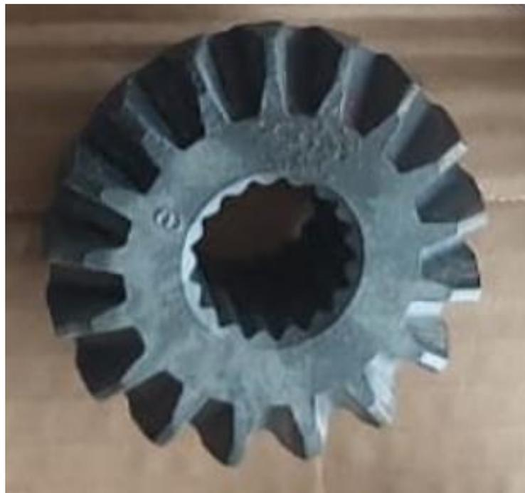
**Figura 3.60** Satélite de transmisión después de ser arenado
