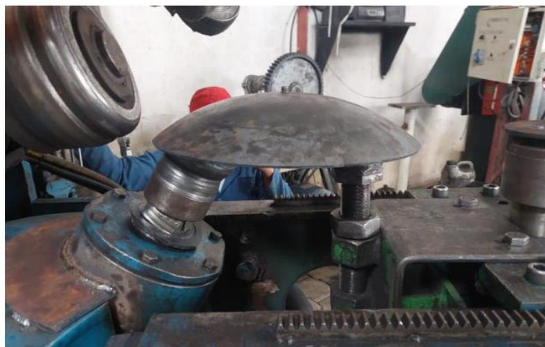
**Figura 2.14** Máquina rebordeadora en tapa de tolva
