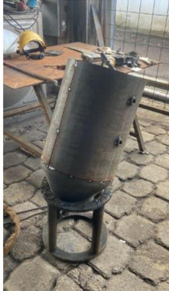
**Figura 2.16** Unión por suelda de cilindro y tolva
