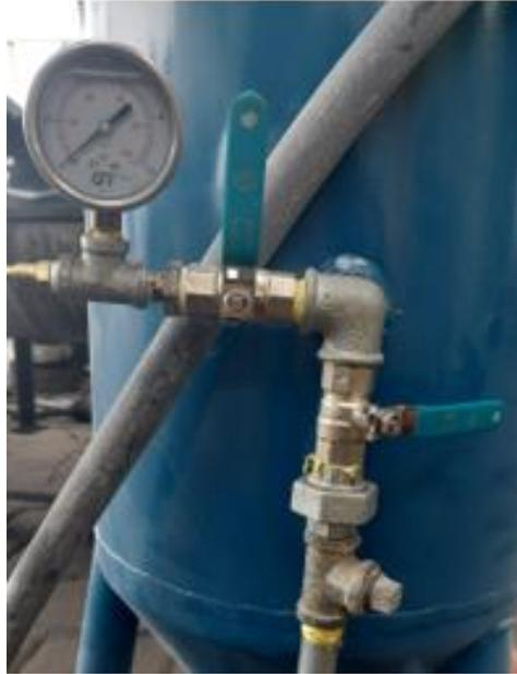
**Figura 3.44** Válvulas en la máquina de limpieza por arenado
