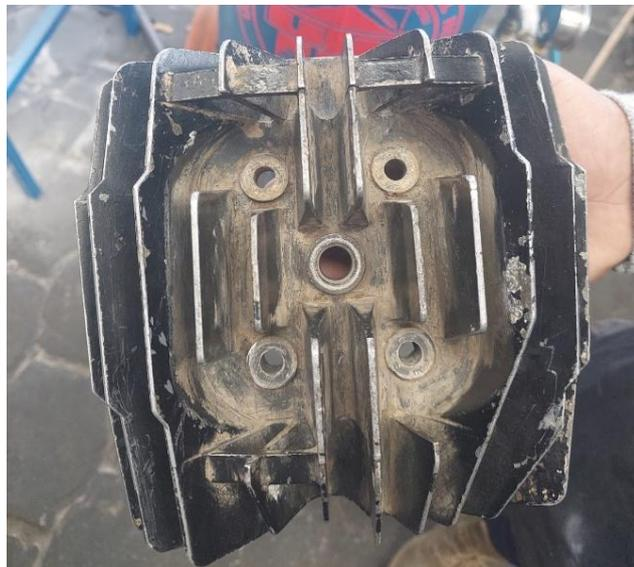
**Figura 3.40** Culata de motor de motocicleta antes de limpieza por arenado
