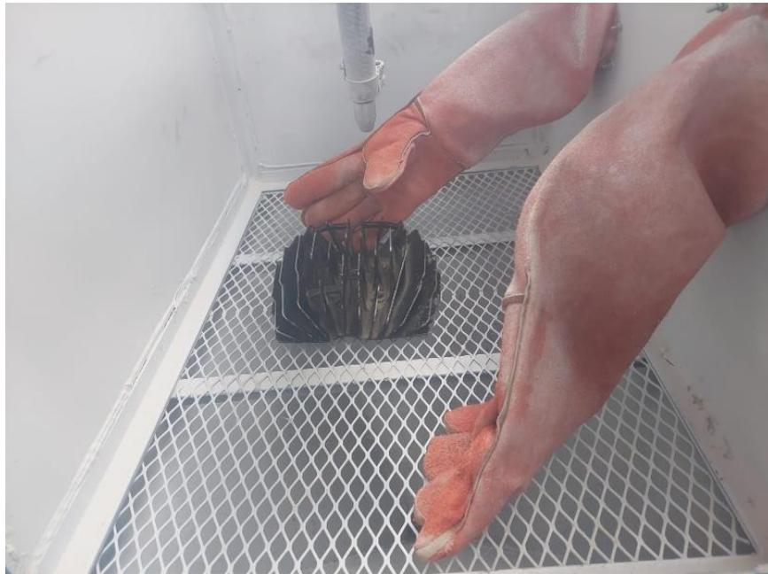
**Figura 3.41** Autoparte dentro de cabina para ser arenada
