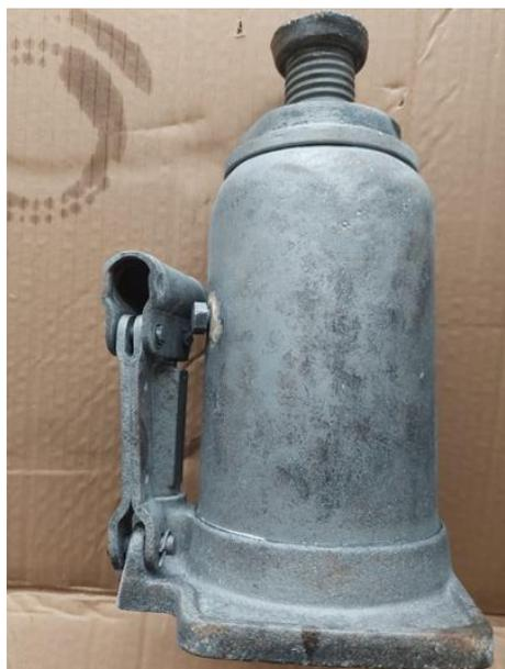
**Figura 3.62** Gato Hidráulico después de ser arenado
