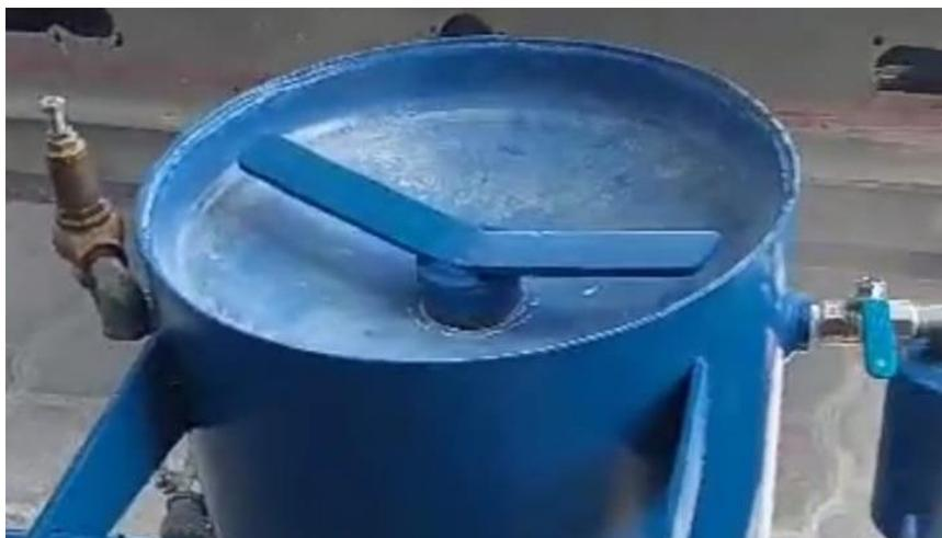
**Figura 3.27** Tapa de máquina de limpieza por arenado
