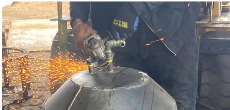
**Figura 3.5** Adaptación de boquilla para entrada de agua de prueba hidrostática
