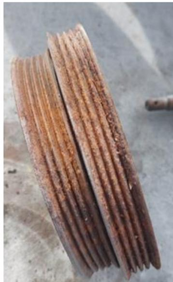
**Figura 3.25** Autoparte destinada a ser arenada
