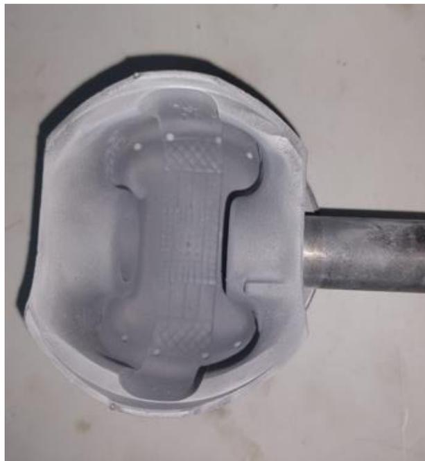
**Figura 3.52** Pistón de motor después de ser arenado
