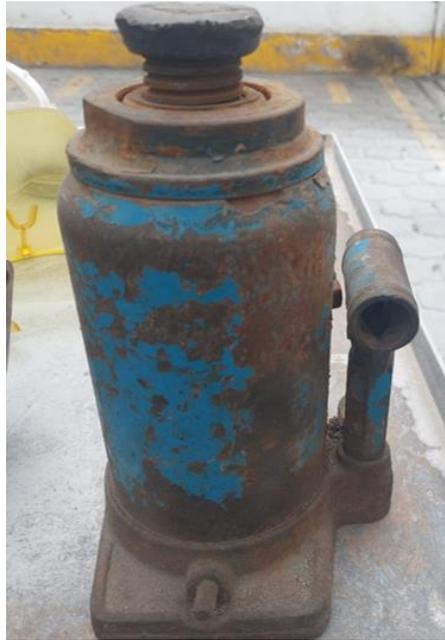
**Figura 3.61** Gato Hidráulico antes de ser arenado
