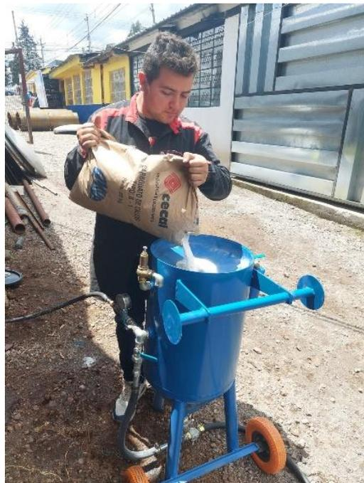
**Figura 3.42** Colocación de material abrasivo
