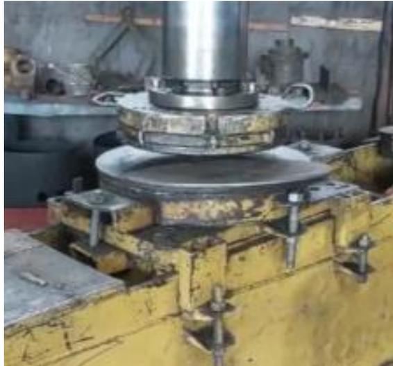
**Figura 2.13** Prensa de pandeo para la tapa superior de la tolva
