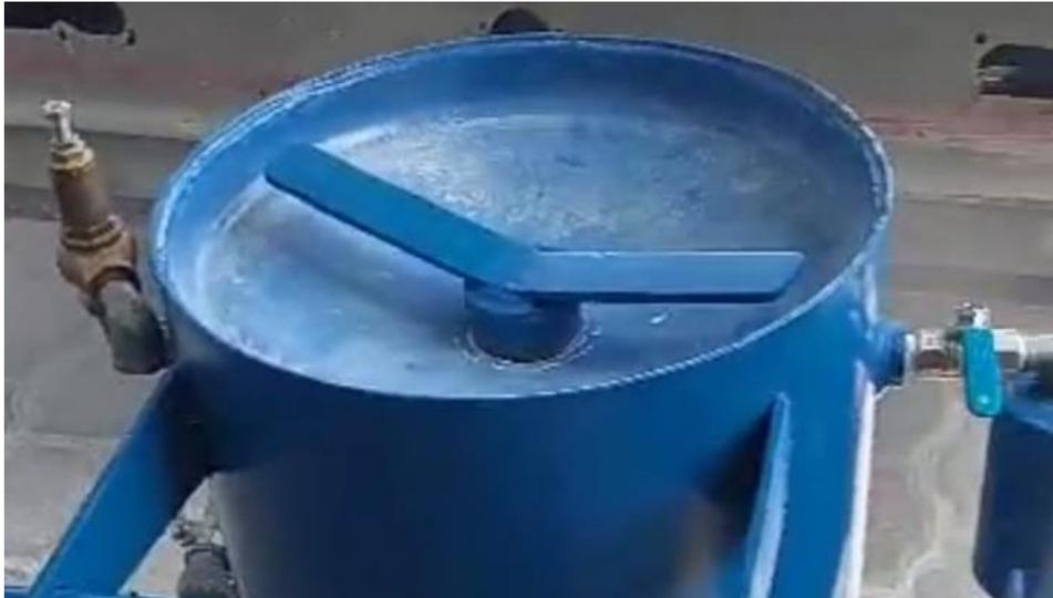
**Figura 3.43** Tapa de máquina de limpieza por arenado
