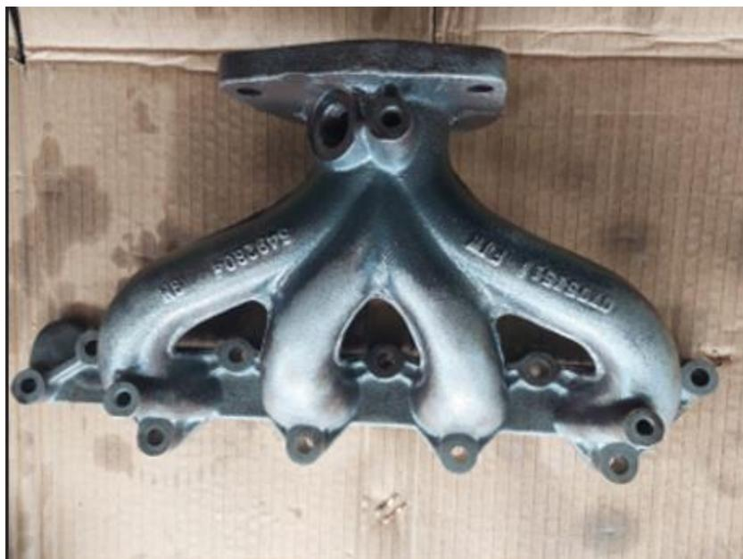
**Figura 3.58** Múltiple de escape después de ser arenado
