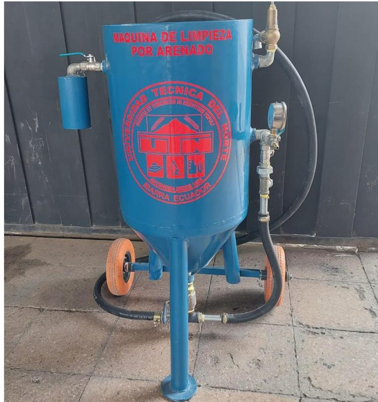
**Figura 2.19** Máquina de limpieza por arenado terminada
