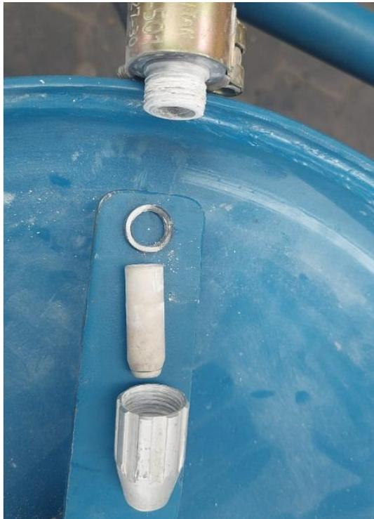
**Figura 3.24** Desmontaje de punta de máquina de limpieza por arenado
