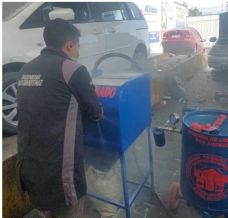
**Figura 3.45** Limpieza por arenado con cabina
