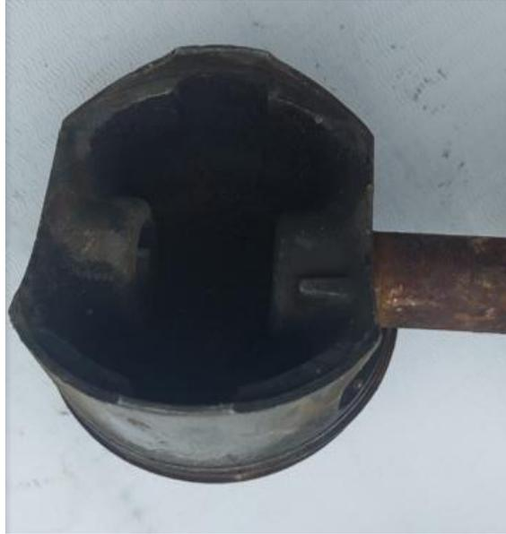
**Figura 3.51** Pistón de motor antes de ser arenado
