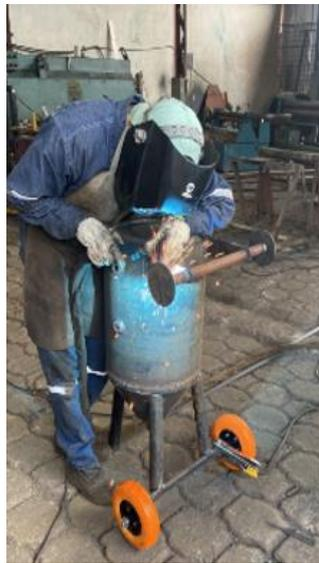
**Figura 2.17** Armado de patas, ruedas y jaladeras
