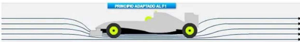
**Figura 2.18** Efecto Venturi Adaptado a un F1
