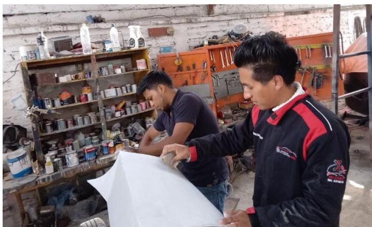
**Figura 3.51** Lijado suave después de aplicar fondo base
