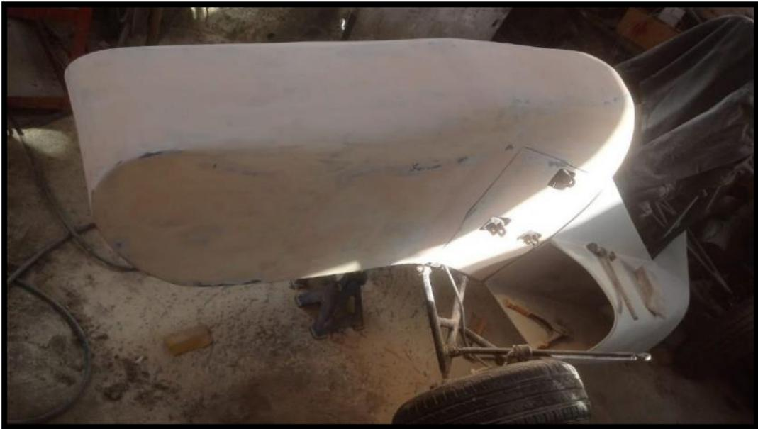
**Figura 3** Masillado de toda la carrocería
