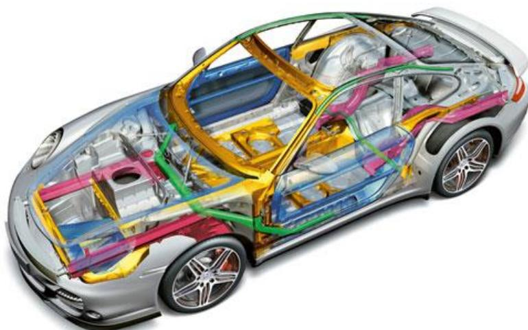
**Figura 3.1** Distintos materiales en la carrocería
