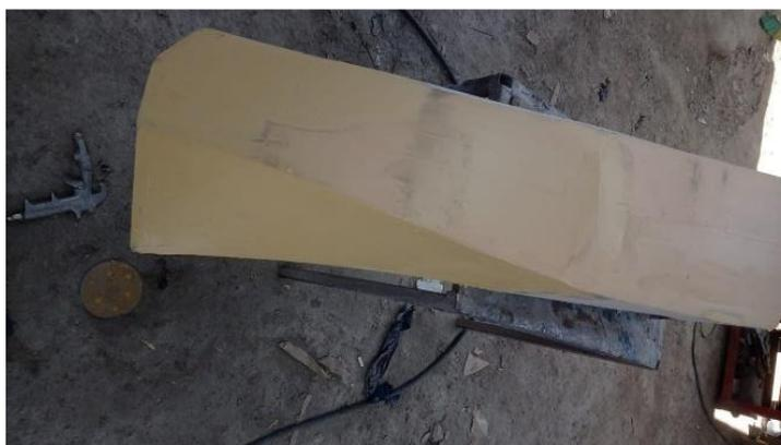
**Figura 3.47** Aplicación de la masilla epoxi de titanio
