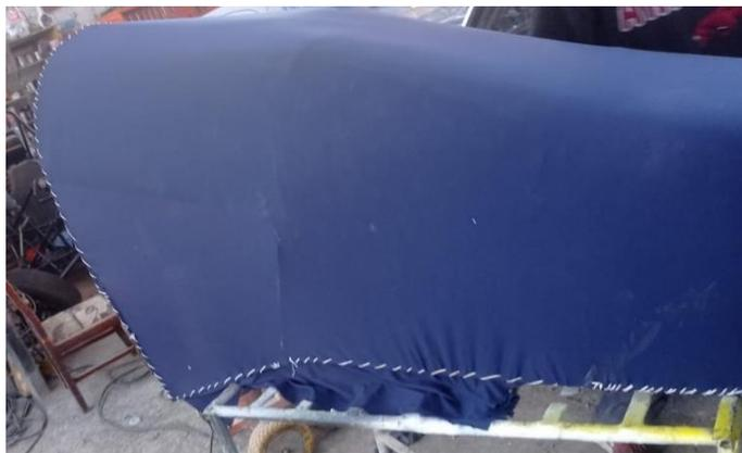
**Figura 3.42** Molde base a través de una lámina de tela
