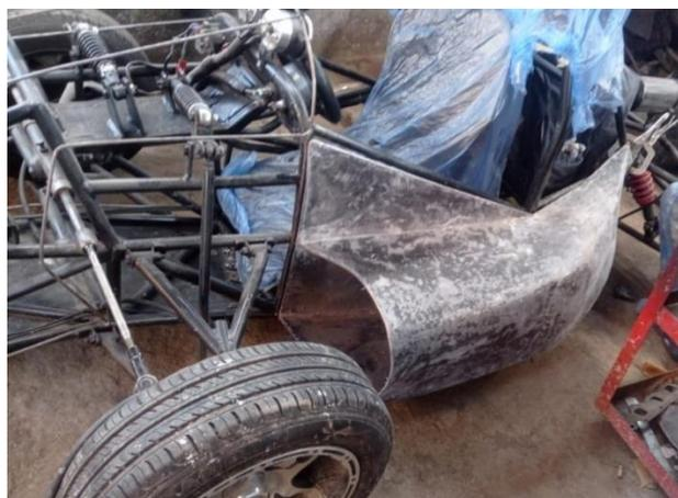
**Figura 3.45** Molde del pontón listo para masillar
