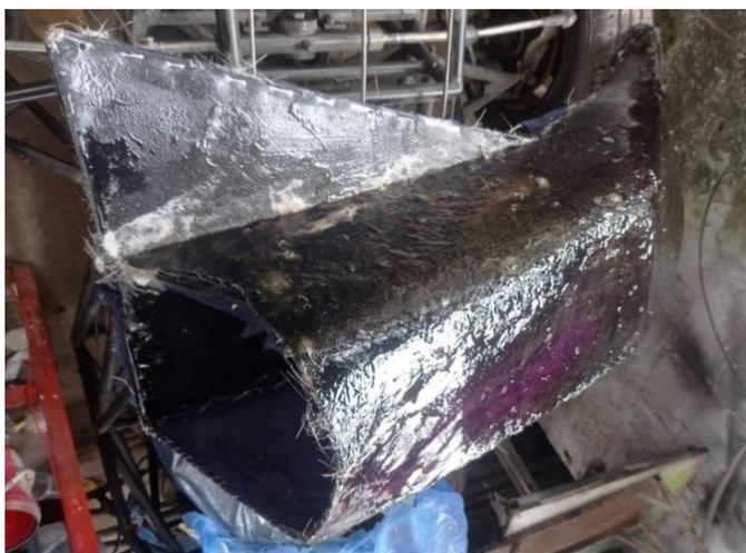
**Figura 3.44** Aplicación de la fibra de vidrio
