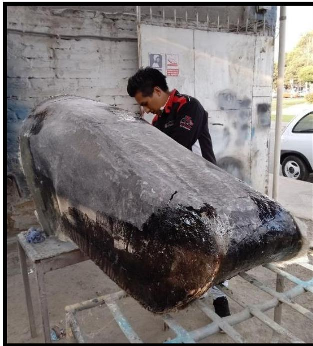
**Figura 2** Aplicación de la fibra de vidrio
