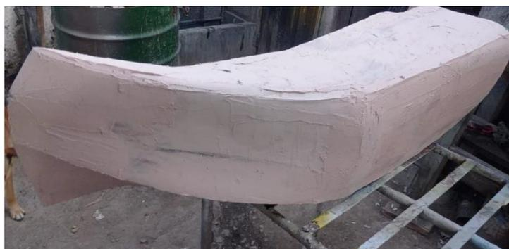
**Figura 3.46** Aplicación de masilla de relleno al pontón
