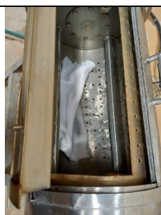
Colocar en la máquina agua, sustrato textil y auxiliares.
