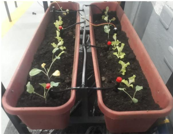
Figura C.3: Ubicación de los goteros ajustables
