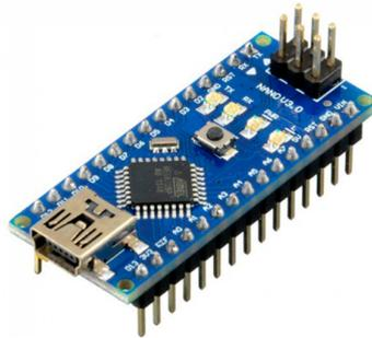
Figura 2.3: Placa Arduino Nano [41].
