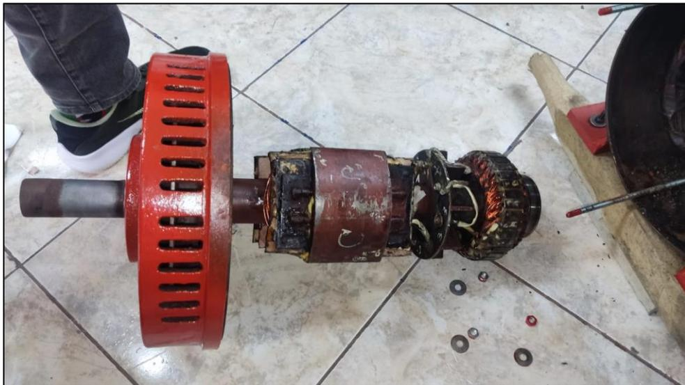
Figura 19, Condición inicial del rotor del G.S bifásico.
