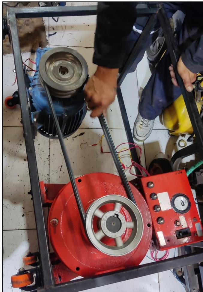
Figura 41, Bandas de goma colocadas en los acoples.
