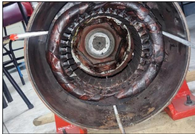
Figura 27, Estado inicial del estator con su aislamiento.
