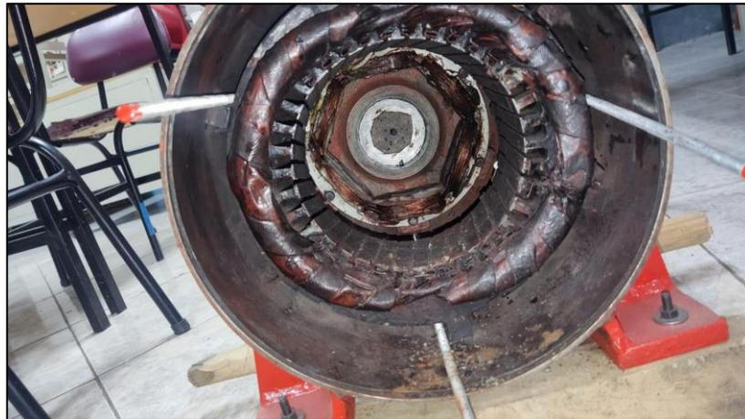
Figura 20, Condición inicial del estator del G.S bifásico.
