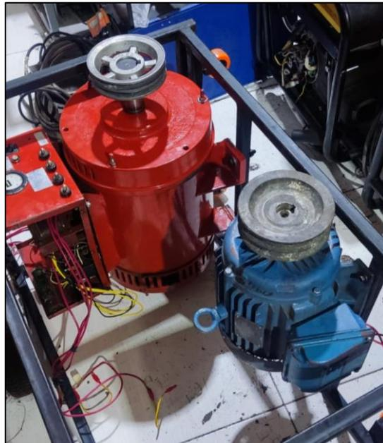
Figura 40, GS trifásico y motor impulsor con sus respectivos acoples.
