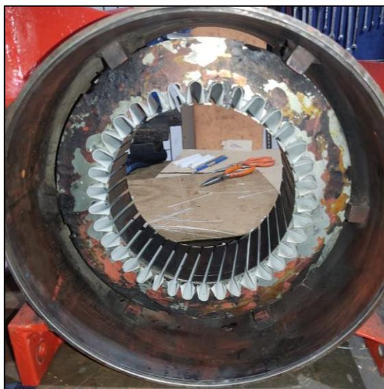
Figura 30, Ranuras del núcleo aisladas con papel aislante.
