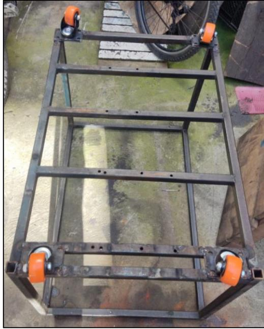
Figura 39, Estructura soldada con ruedas de 360 grados.
