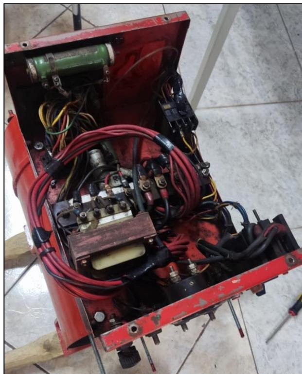
Figura 21, Tablero de conexiones y autoexcitación del G.S bifásico.
