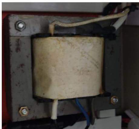
Figura 25, Transformador reductor.
