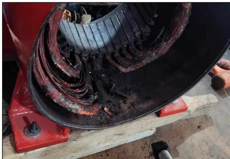
Figura 28, Conductores de los devanados al descubierto sin aislante.
