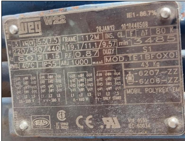
Figura 18, Placa de datos del motor impulsador.
