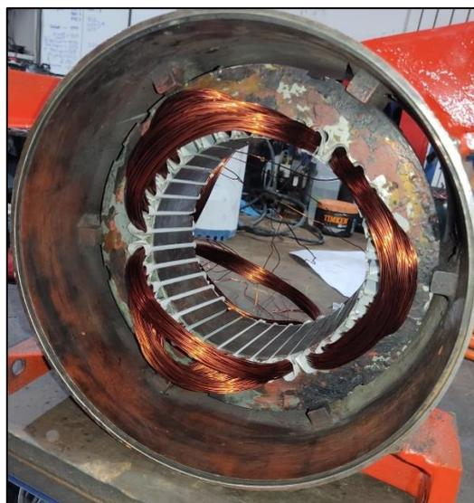
Figura 32, Devanados colocados y sellados con tapas de plástico en cada ranura.
