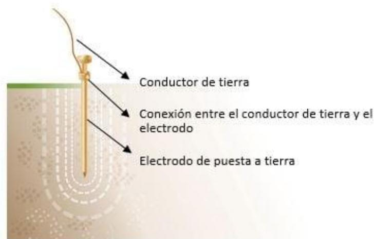
Fig. 12 Sistema de puesta a tierra (SPT) [10]
