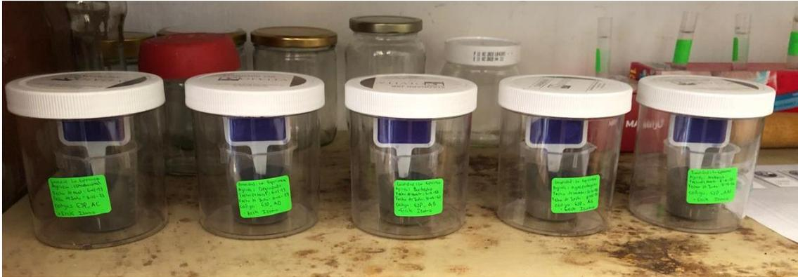
Tras el periodo de reposo, se observó el cambio de color en el gel de la sonda Solvita (Figura 10). Este gel contiene compuestos químicos que permiten determinar la cantidad de CO<sub>2</sub> emitido, con valores que oscilan entre 0% y 3%.
