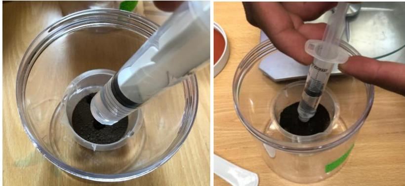
Una vez preparada la muestra, se colocó en el vaso medidor dentro del frasco hermético Solvita. A continuación, se insertó la sonda que mide la emisión de dióxido de carbono (Figura 8).
