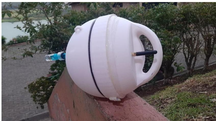
3. Imagen de recubrimiento del Nodo Sensor con resina poliéster y posterior pintado.
