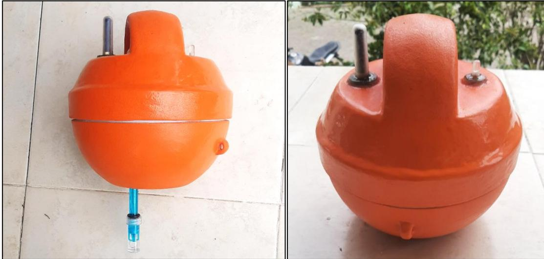
*Nota: En la figura se puede visualizar el Nodo Sensor ensamblado en su totalidad, tanto con su antena LoRa, LED indicador y sensores.*
