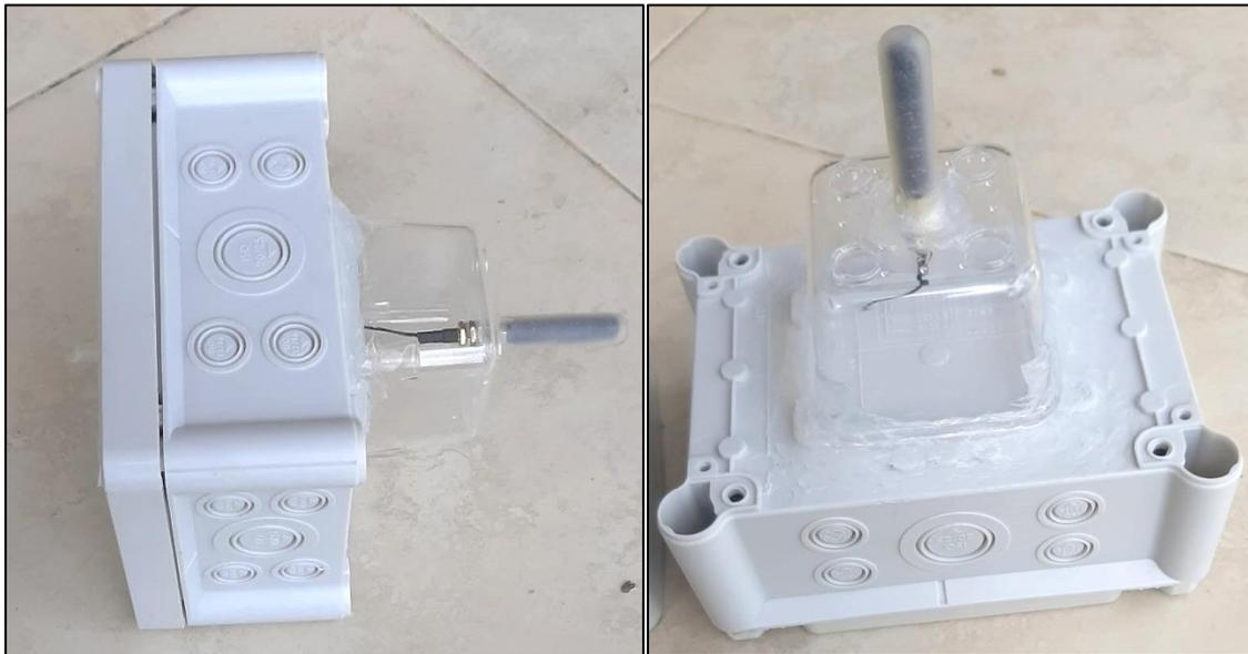
*Nota: En la figura se puede visualizar la caja de pase eléctrica utilizada como cobertura de los componentes electrónicos de la Boya de Comunicaciones con la antena LoRa insertada en su estructura.*
