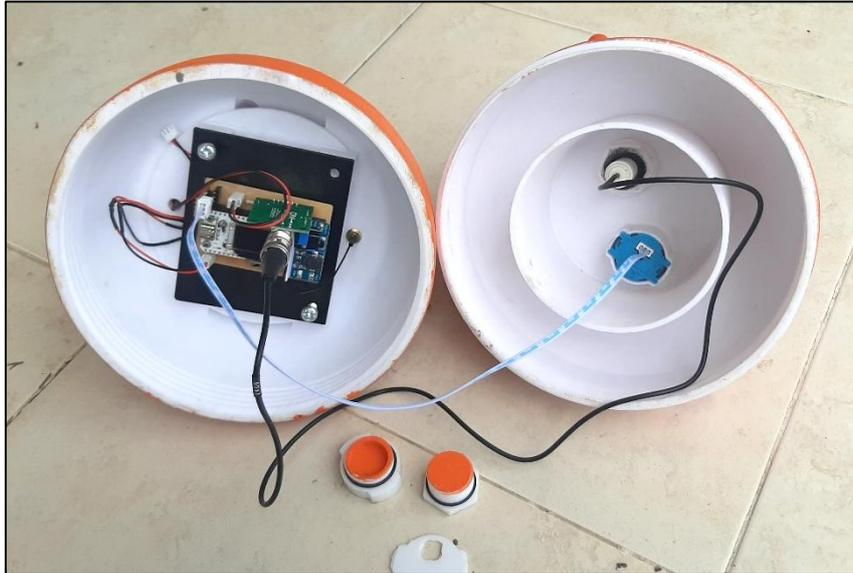
*Nota: En la figura se puede visualizar toda la conexión de los componentes electrónicos que integran al Nodo Sensor, en este caso las sondas se encuentran conectadas a la placa electrónica.*
