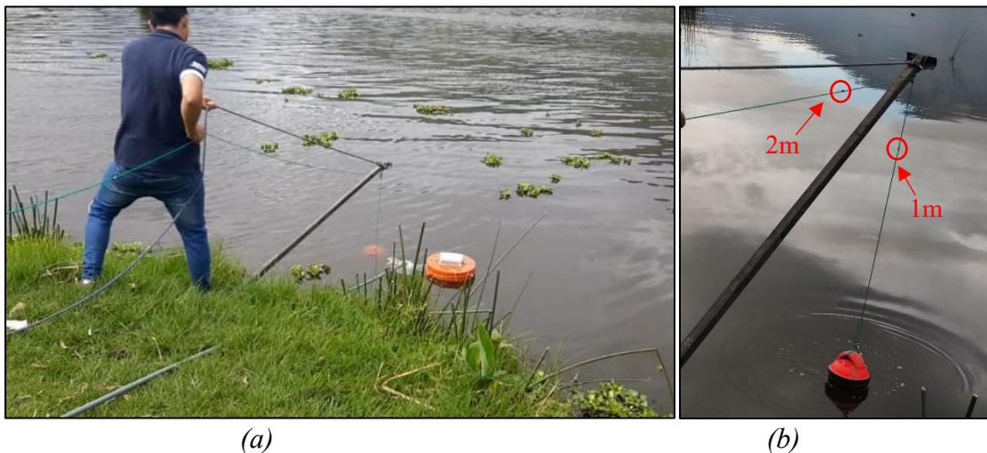
*Nota: En la figura se puede visualizar la instalación del Nodo Sensor en la Laguna de Yahuarcocha, se observa un sistema de polea (a) así como una cuerda de sujeción marcada cada metro.*
