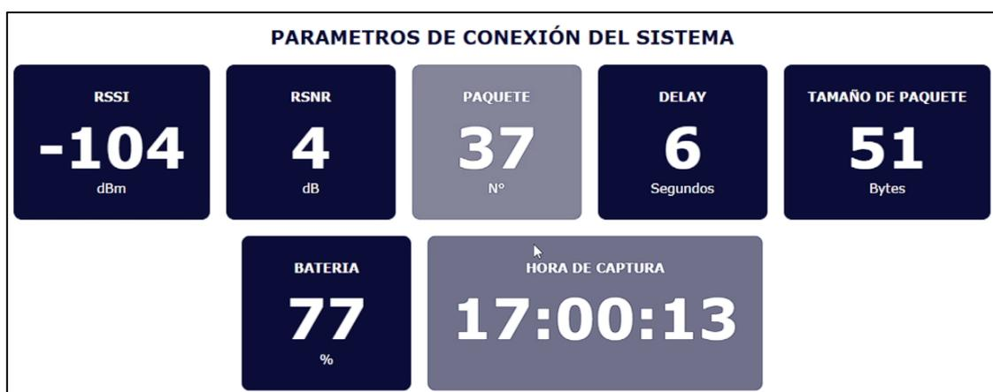
*Nota: En la figura se puede visualizar la presentación de los parámetros de conexión de cada uno de los paquetes que se transmiten entre el Nodo Sensor y la Boya de Comunicaciones en la interfaz de usuario.*
