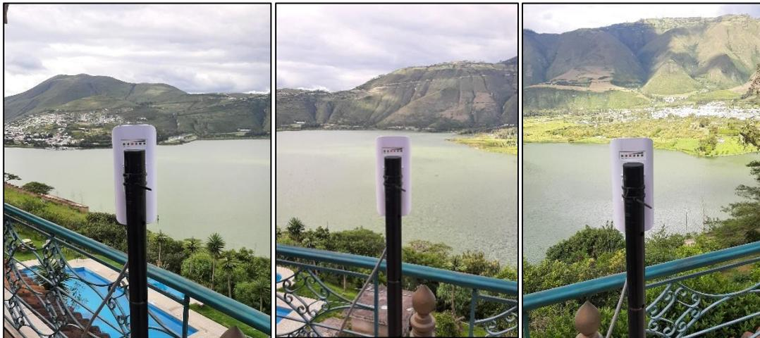
*Nota: En la figura se puede visualizar la antena Ubiquiti Loco M2 utilizada para dar conexión Wifi hacia diferentes sectores de la Laguna de Yahuarcocha.*
