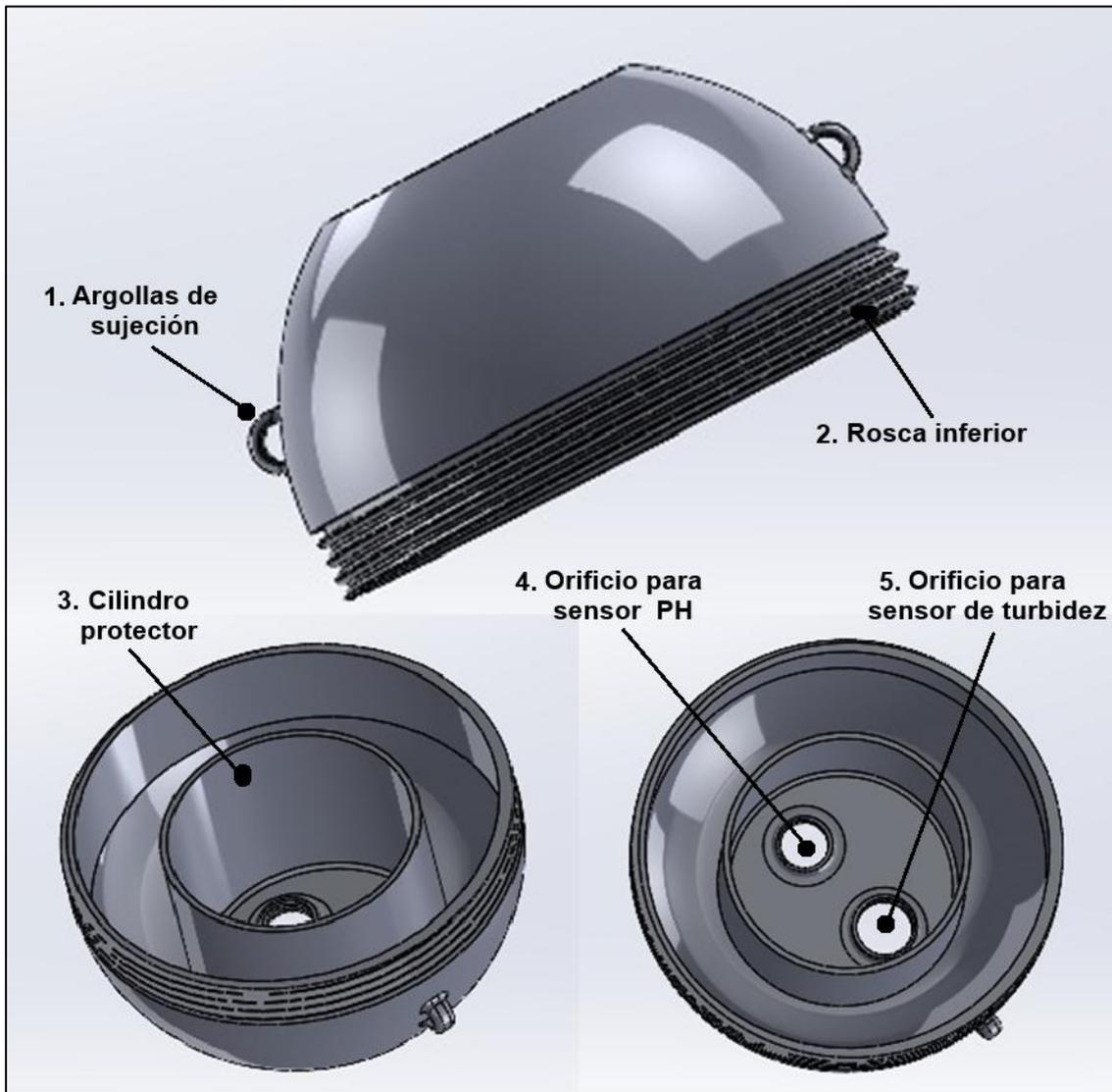
*Nota: En la figura se observa la cubierta inferior de la esfera (Nodo Sensor), aquí se detallan todas las partes principales del modelo en cuestión.*
