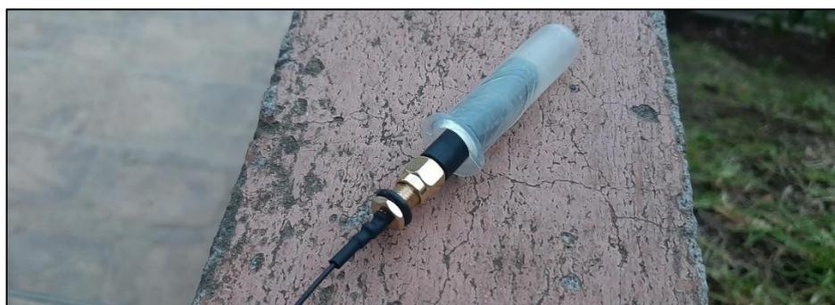
*Nota: En la figura se puede visualizar la cubierta de resina ABS que se utilizará para proteger la antena LoRa.*
