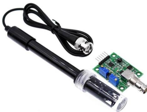
*Nota: En la figura se observa el kit sensor pH-4502 el cual contiene el módulo de conexión y la sonda electrodo E201, imagen recupera de (UNIT Electronics, 2024).*
