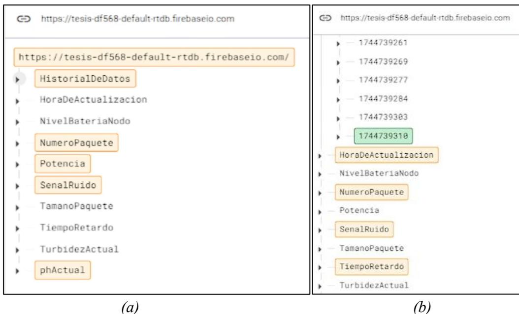
*Nota: En la figura se puede visualizar la actualización de datos en tiempo real (a) y el almacenamiento del historial de datos mediante el timestamp (b).*
