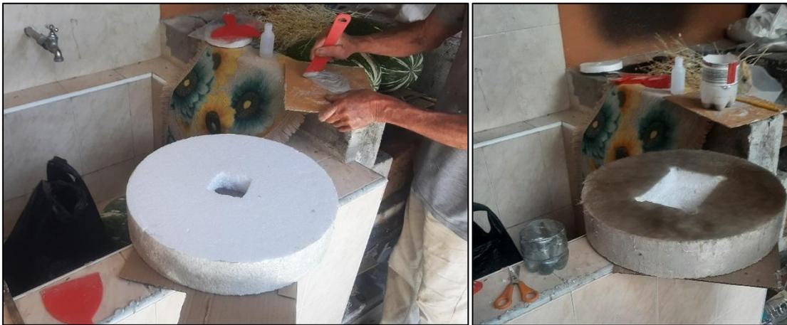
5. Imagen de material flotante de la Boya de Comunicaciones recubierto con resina poliéster y fibra de vidrio.
