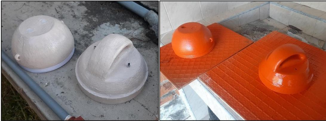
4. Aplicación de pasta de resina poliéster y fibra de vidrio al material flotante de la Boya de Comunicaciones.
