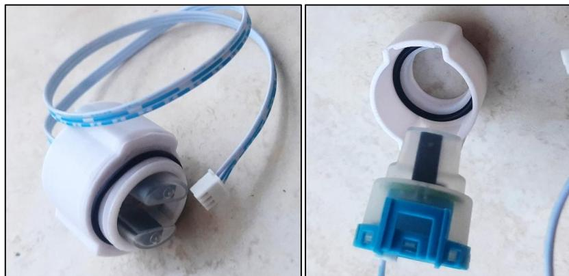
*Nota: En la figura se puede visualizar el módulo de cobertura que contiene el sensor de Turbidez de agua.*
