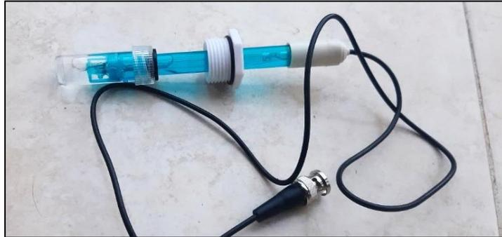
*Nota: En la figura se puede visualizar la sonda de pH con su respectivo sujetador hermético.*
