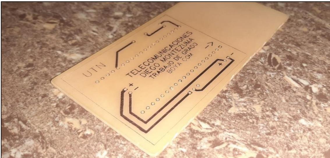
*Nota: En la figura se puede visualizar la PCB que se ha obtenido a partir del esquema representado en la figura 34.*
