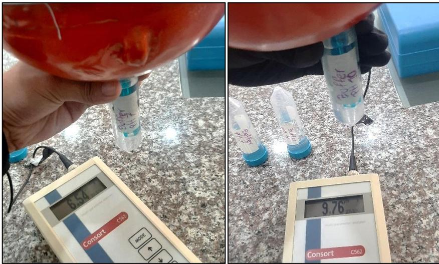
4. Calibración de sonda pH con el Analizador Multiparamétrico.
