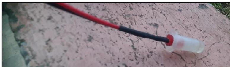
*Nota: En la figura se puede visualizar la cubierta de resina ABS que se utilizará para proteger el LED indicador.*
