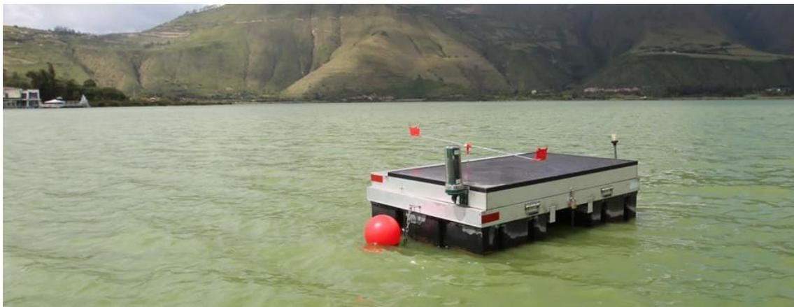
*Nota: En la figura se observa una de las 7 plataformas de ultrasonido que se utilizan en la Laguna de Yahuarcocha con el objetivo de controlar la proliferación de microorganismos, imagen recuperada de (La Hora, 2022b).*
