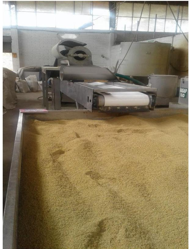
Banda transportadora y horno secador de
