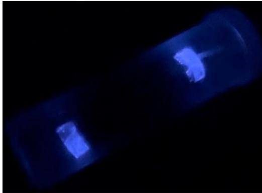
**Fig. 29** Descargas eléctricas en el reactor (DBD)
