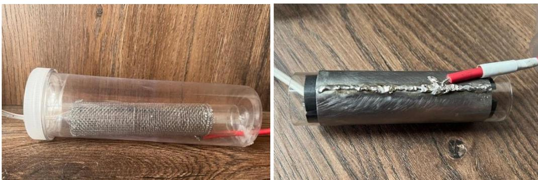
**Fig. 24** Celda para las descargas dieléctricas dentro de la cámara.
