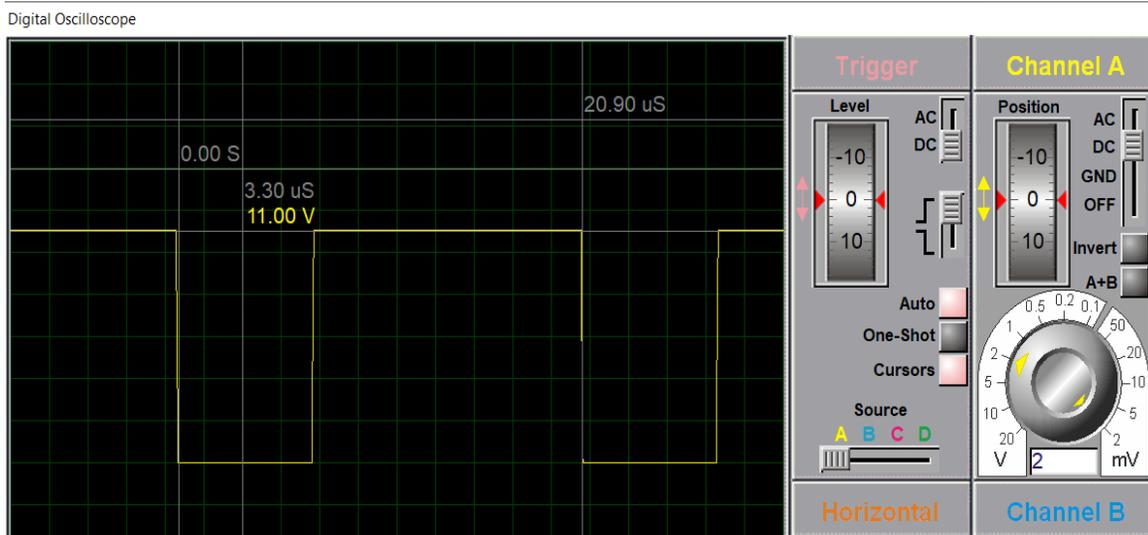
**Fig. 20** Medición de voltaje y frecuencia de salida máxima del circuito.
