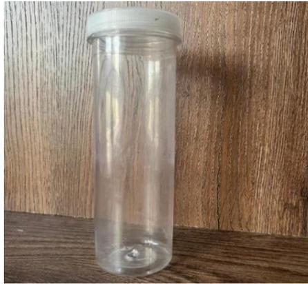
**Fig. 23** Modulo cilíndrico de plástico como cámara del reactor
