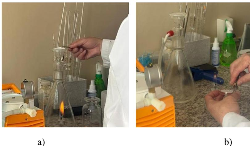
**Fig. 35** Método de filtración por membrana para los análisis microbiológicos, **a)** colocación de la membra para el filtro, **b)** colocación de la membraba para el cultivo.
