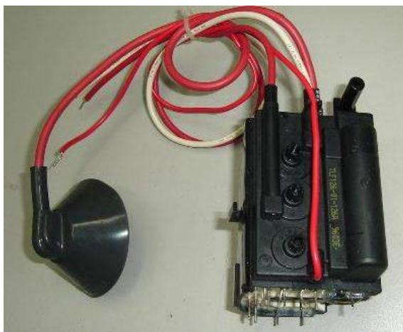
**Fig. 13** Transformador Flyback
