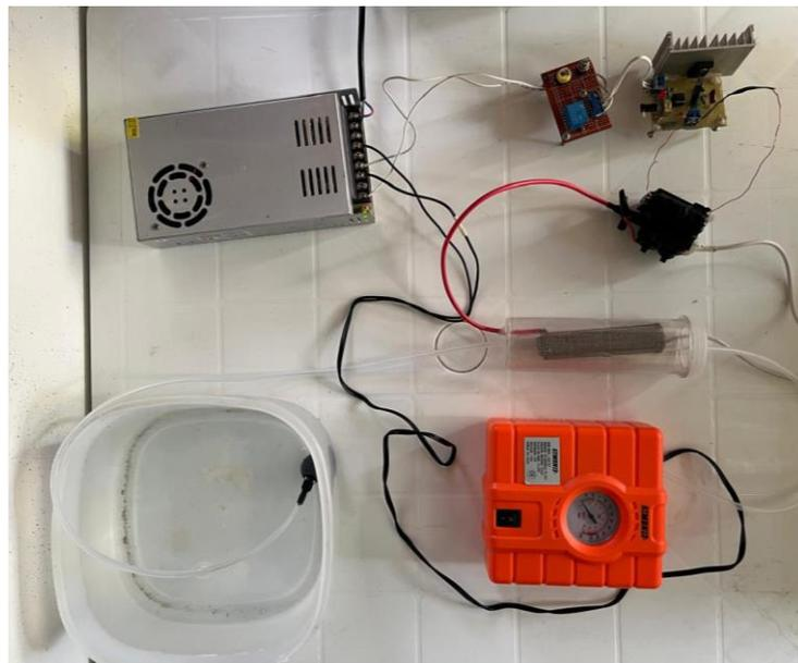
**Fig. 41** Funcionamiento del sistema ozonificador
