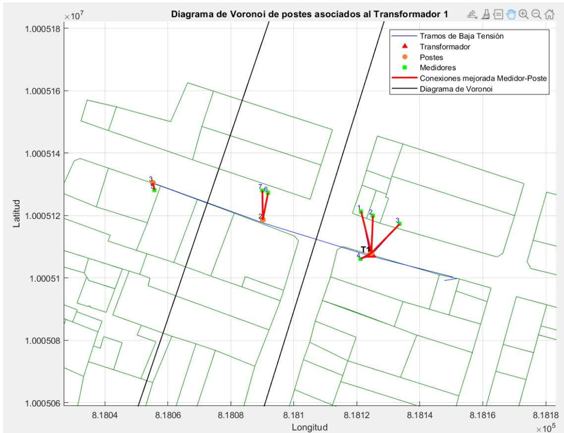
*Fig. 20 Reconfiguración de medidores al poste más cercano del transformador 81956.*
