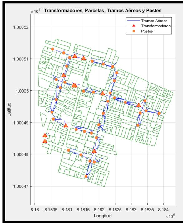
*Fig. 12 Sistema eléctrico del sector de estudio Modelado en MATLAB.*
