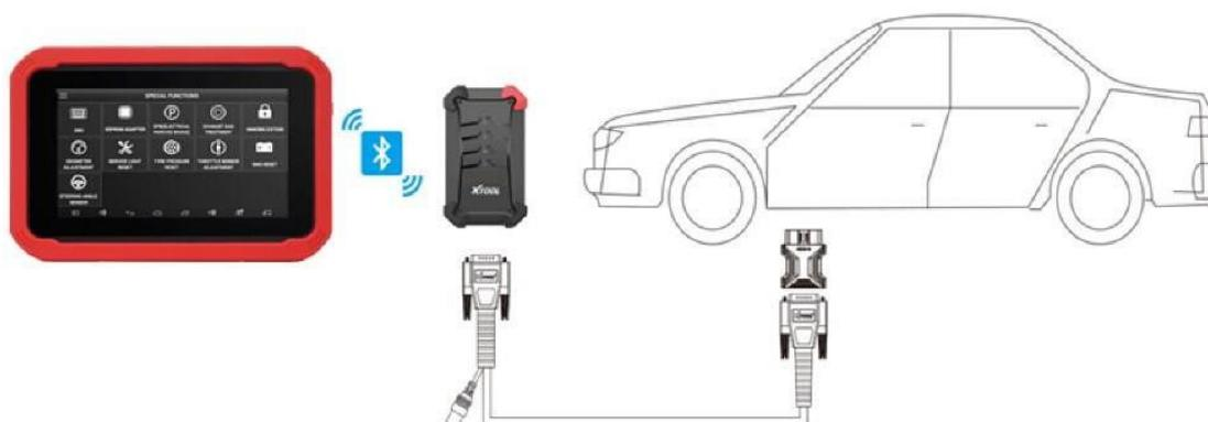
Fig. 3.9. Conexión apropiada del escáner Launch X431 Pro GT al vehículo [50].
