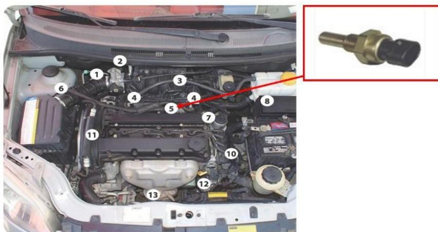
Fig. 2.8. Ubicación del sensor ECT en el motor referencia [20].
