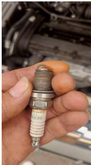
**Fig. 3.7. Bujías en mal estado**
