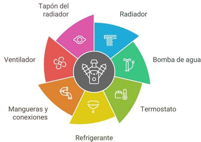
**Fig. 2.4. Componentes del sistema de Refrigeración del Motor [11].**
