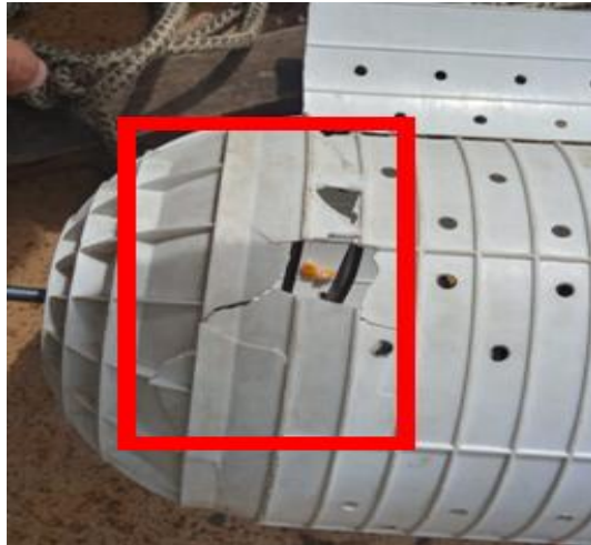
Fig. 4.40 Falló de contenedor del prototipo.
