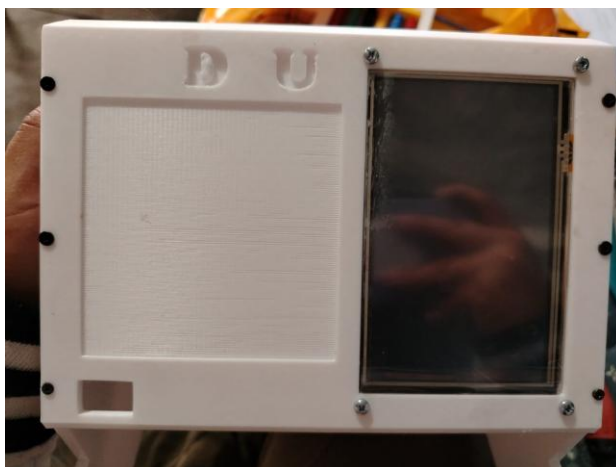
Fig. 4. 26 Ensamble del conjunto carcasa-pantalla
