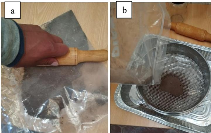
Nota: a) Muestra de suelo triturado en funda plastica b) Tamizado de la muestra de suelo
