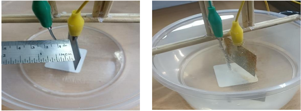
Figura 27. Distancia entre ánodo y cátodo de 1cm con 1.58 V
