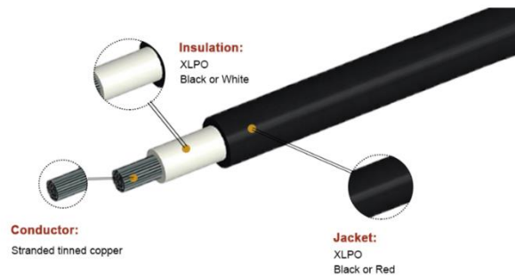
Fig. 3 Estructura del cable PV-Wire [33]
