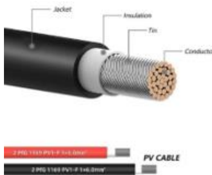
Fig. 2 Estructura del cable pv1-f [31]
