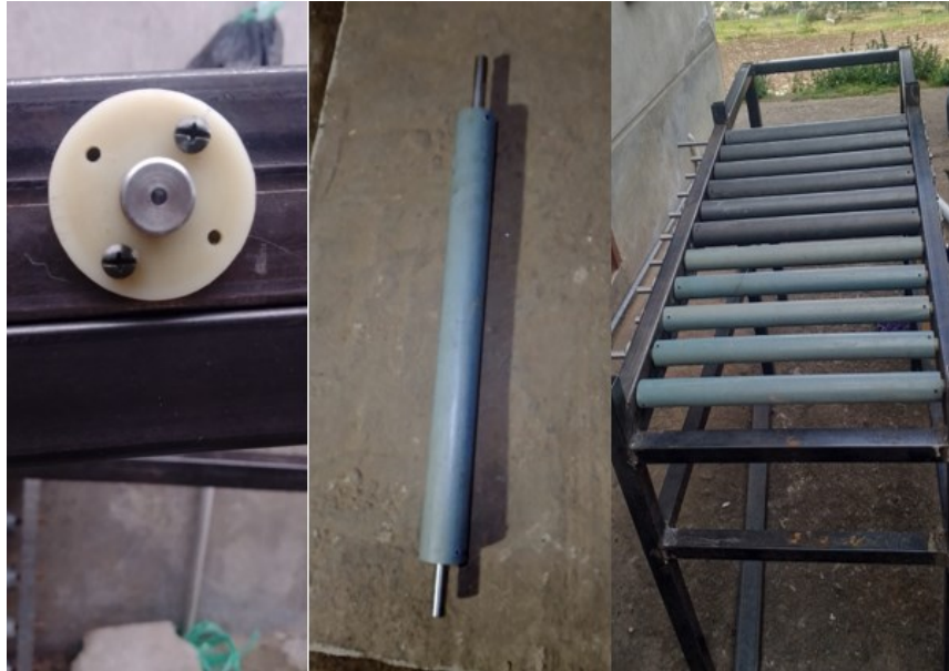
Fig. 4.29 Ensamblado de los rodillos en la estructura principal.
