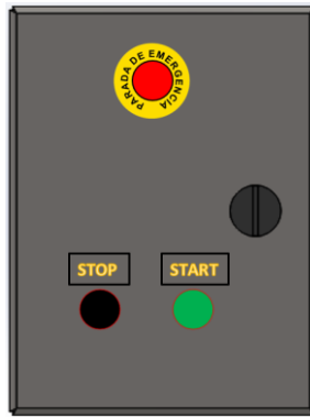
Fig. 4.16 Gabinete que integra componentes eléctricos.
