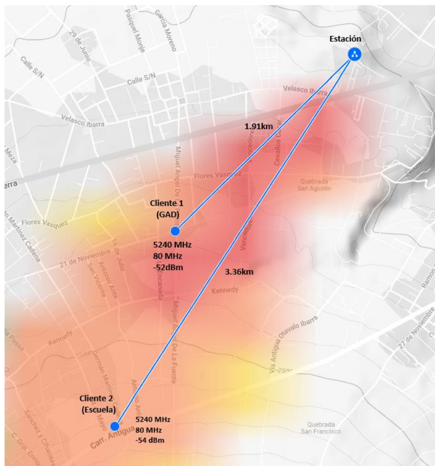
Figura 7. Mapa de propagación y cobertura del enlace RILD generado con UISP. Fuente: Elaboración propia.
