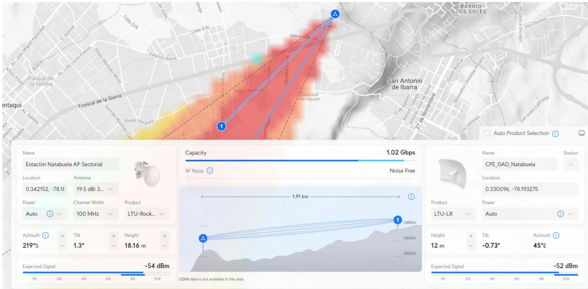
Figura 8. Perfil de elevación y parámetros del enlace punto a punto estación-cliente1. Fuente: Elaboración propia en base a simulación en UISP.
