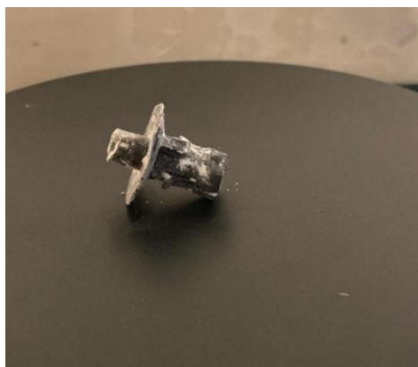
Figura 42. Brida de compuerta trasera con talco
