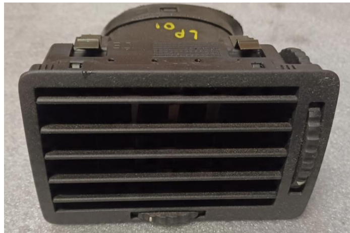
Figura 32. Rejillas del aire acondicionado
