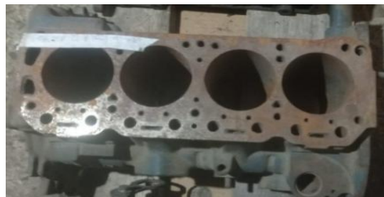
Figura 26 Bloque del Nissan Datsun 1200, después de la limpieza
