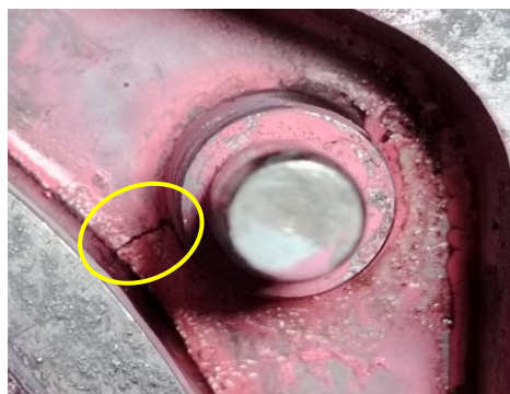
Figura 35 Resultado proyectado de la aplicación de Líquidos Penetrantes en el Motor Briggs Stratton 206.
