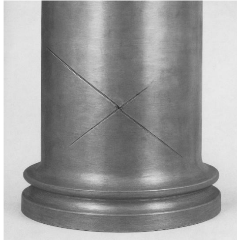
Figura 18 Ejemplo de fisura en forma de estrella
