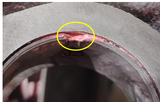
Figura 39 Resultado Proyectado de la aplicación de Líquidos Penetrantes en el Motor Daihatsu Charade 1000.
