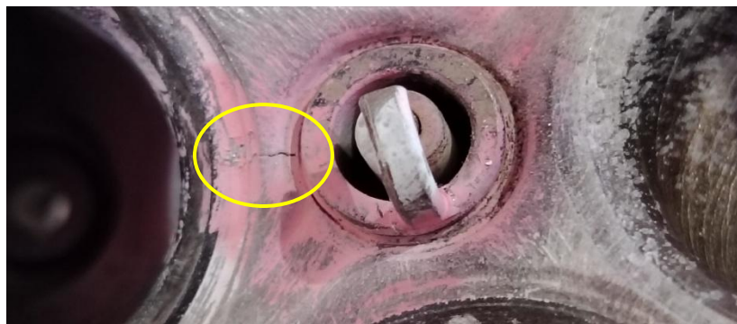
Figura 31 Resultado proyectado de la aplicación de Líquidos Penetrantes en el Motor Mazda 6.
