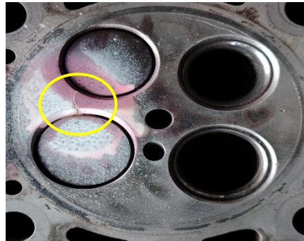
Figura 34 Resultado proyectado de la aplicación de Líquidos Penetrantes en el Cuarto Cilindro del Motor Volkswagen
