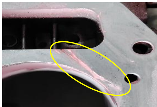
Figura 40 Resultado Proyectado de la aplicación de Líquidos Penetrantes en el Motor Briggs Stratton 206.
