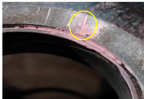
Figura 38 Resultado Proyectado de la aplicación de Líquidos Penetrantes en el Bloque de Motor Nissan Datsun 1200.
