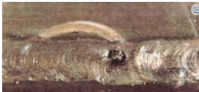
Figura 17 Visualización de inclusión de escoria
