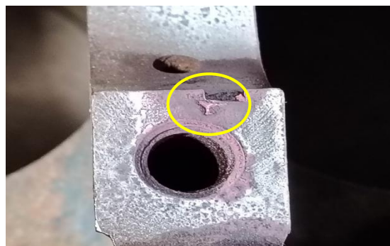
Figura 37 Resultado Proyectado de la aplicación de Líquidos Penetrantes en el Bloque de Motor Nissan Datsun 1200.
