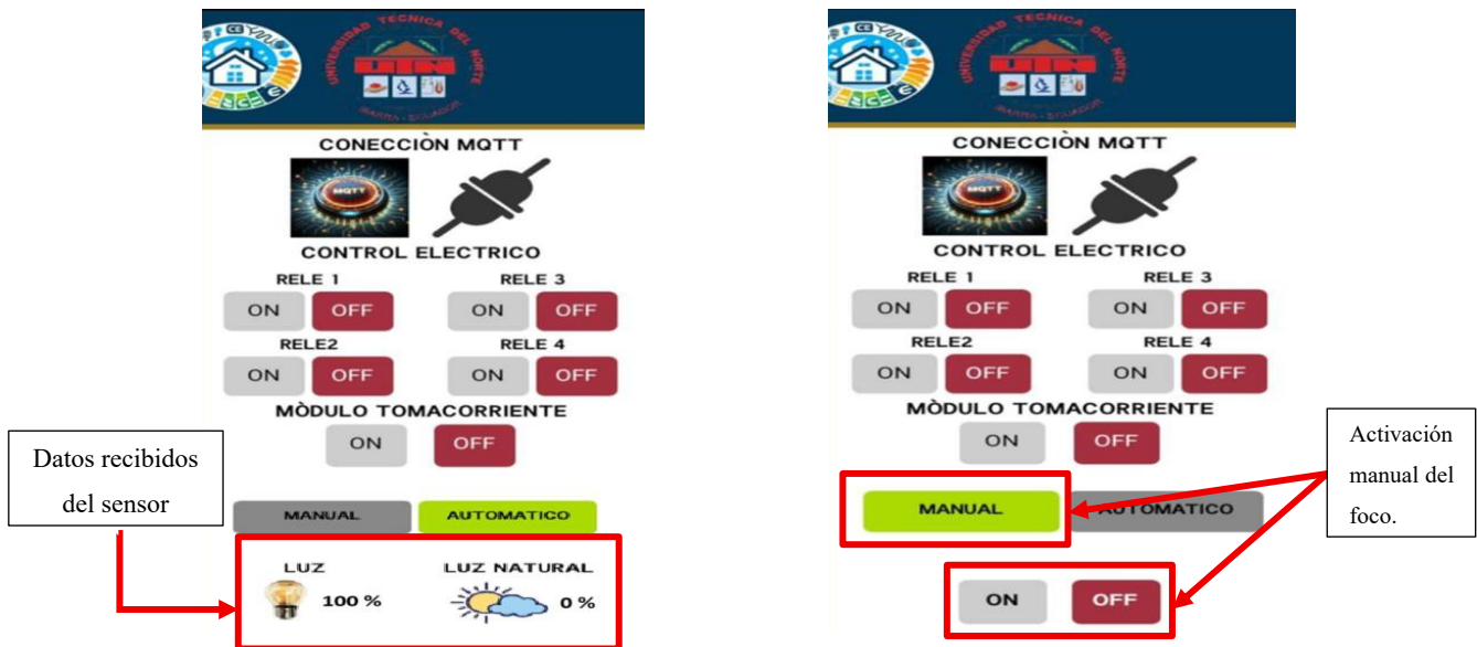
Figura 22. Activación automática desde la App móvil. Figura 23. Activación manual desde la App móvil.
