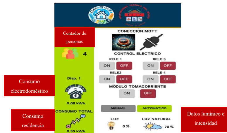
Figura 17. Aplicación móvil con valores de los sensores en tiempo real
