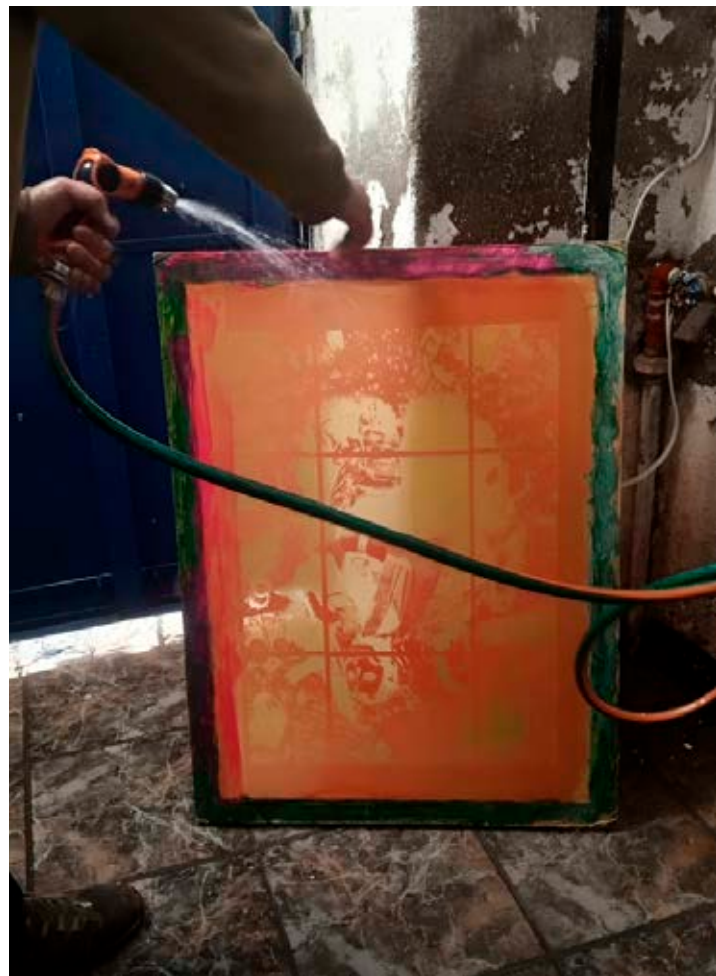
Figura 98 Lavado de malla con agua
