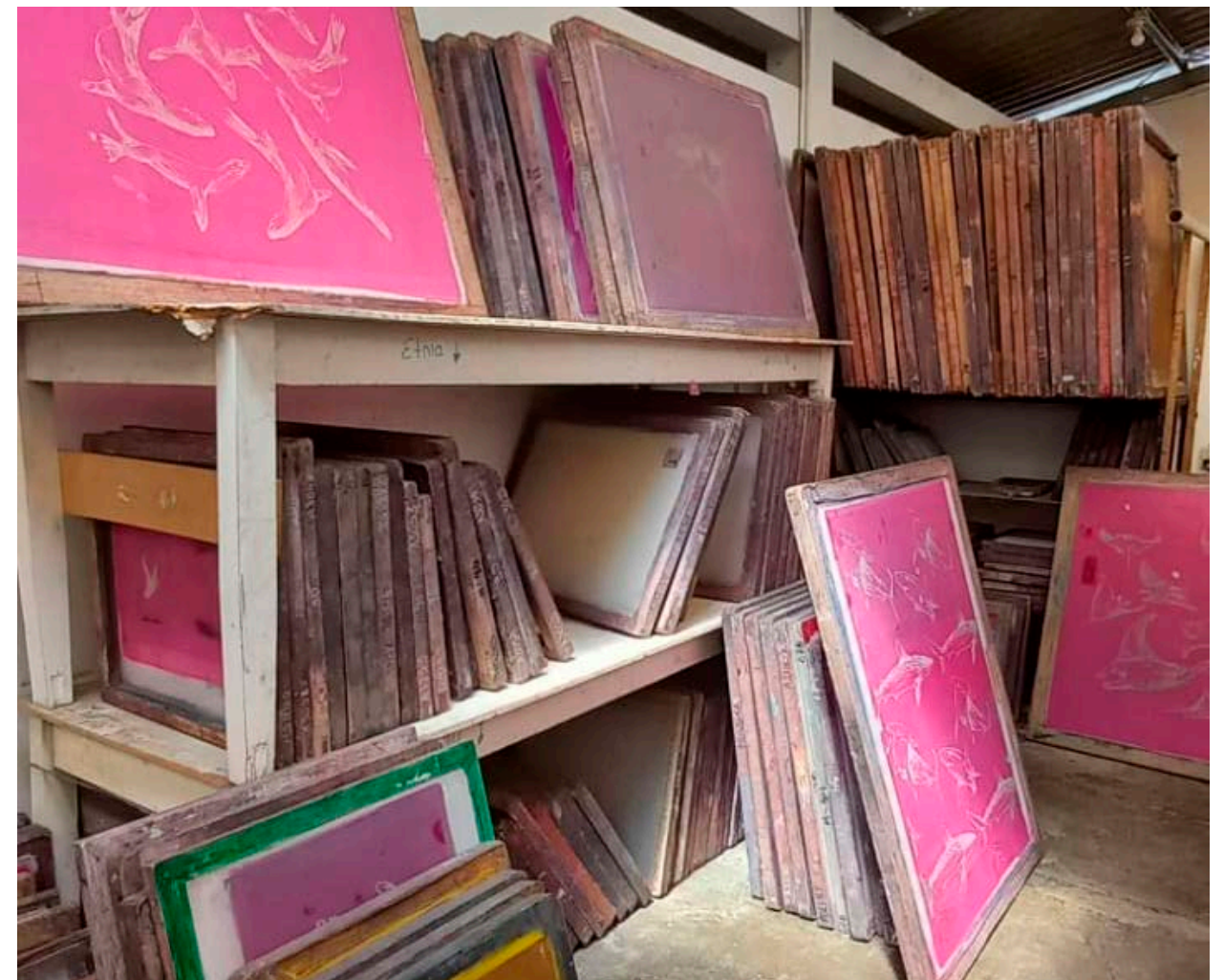
Figura 87 Marcos de madera, tensados
