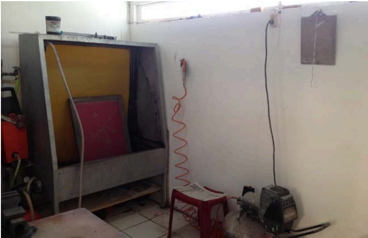
Figura 70 Lavado de mallas
