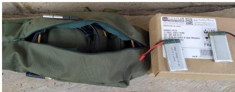
Figura 53. Conexión de batería de litio al nodo móvil.
