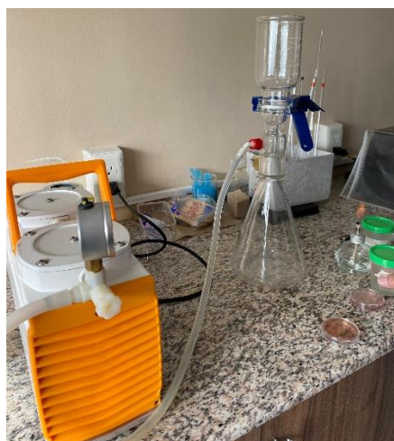
Fig. 20 Proceso de filtración para estudio de coliformes.
