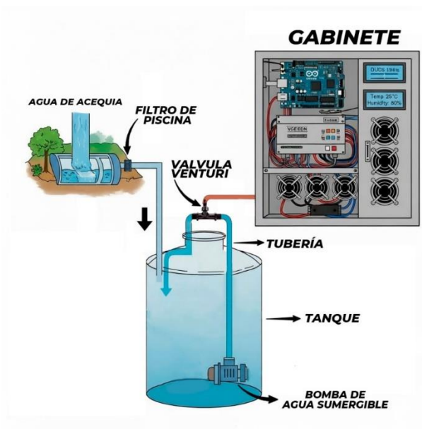
Fig. 2 Sistema de ozonificación planteado.
