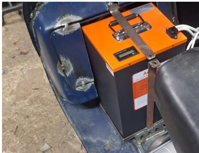
Figura 15. Instalación de la batería
