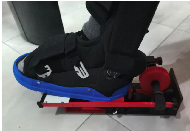
Fig 4. 45 prototipo de bota Walker con integración del sistema de articulación y asistencia al movimiento
