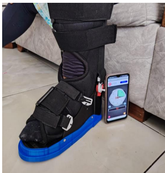
Fig 4. 44 Bota Walker colocada en el usuario durante prueba de ajuste y estabilidad
