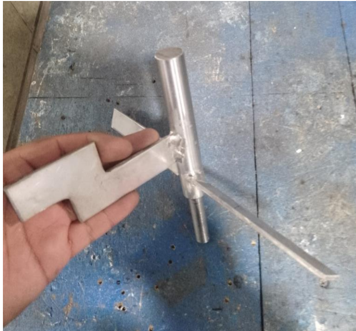
Fig. 4.14 Paletas soldadas a eje de acero inoxidable
