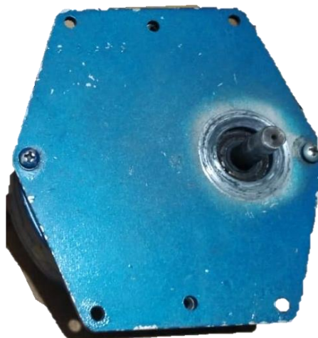
Fig. 4.7 Motorreductor DC 24 V ,100 W.
