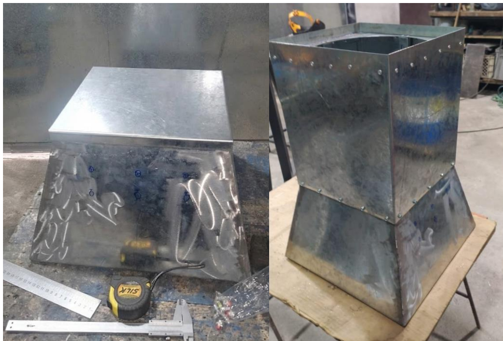
Fig. 4.12 Estructura modular autoportante.
