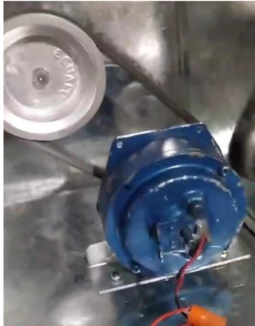
Fig. 4.15 Sistema de transmisión de poleas 2:1
