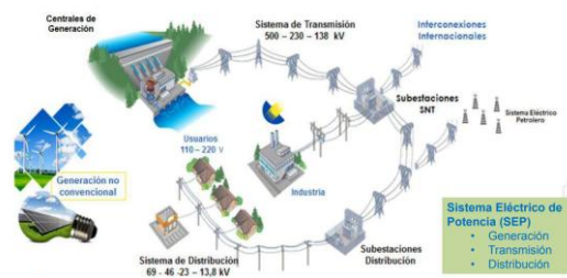
Fig 1: Sistema Eléctrico de Potencia [7]
