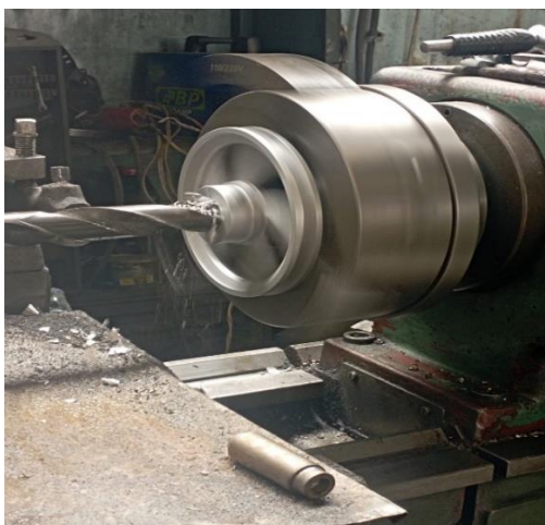
Fig. 4.26 Torneado de las poleas.
