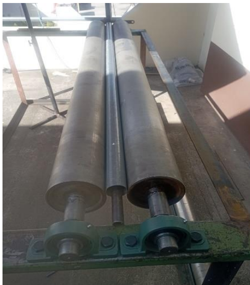
Fig. 4.25 Instalación de las chumaceras con los rodillos.
