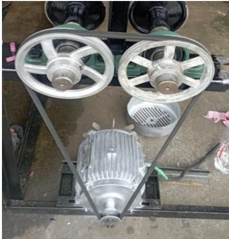
Fig. 4.28 Instalación del sistema de transmisión.
