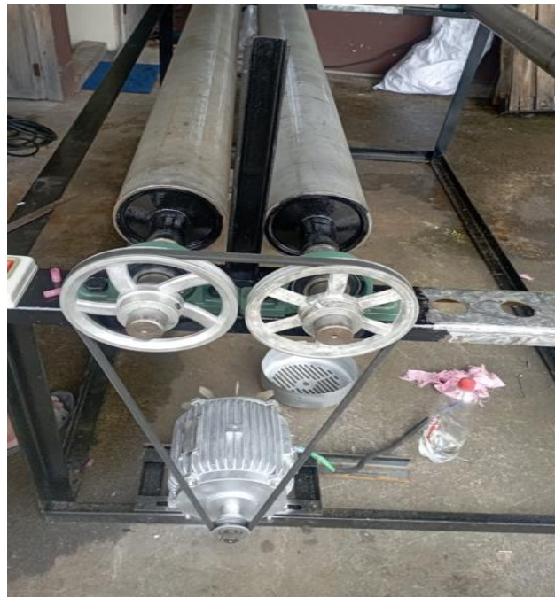
Fig. 4.33 Prueba N°1 sistema de transmisión y eléctrico.
