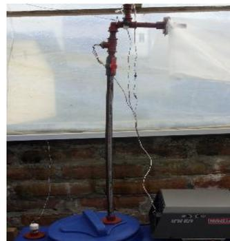
c) Tubería de transporte de biogás
