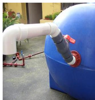
f) Tubería descarga de material
