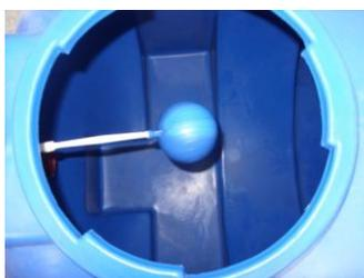
a) Sensor flotador de nivel
