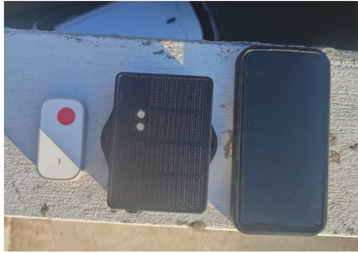
Figura 4.1: Disposición física de los equipos en el punto de prueba. De izquierda a derecha: MokoSmart LW004-PB, Dragino TrackerD-LS y el smartphone de referencia.
