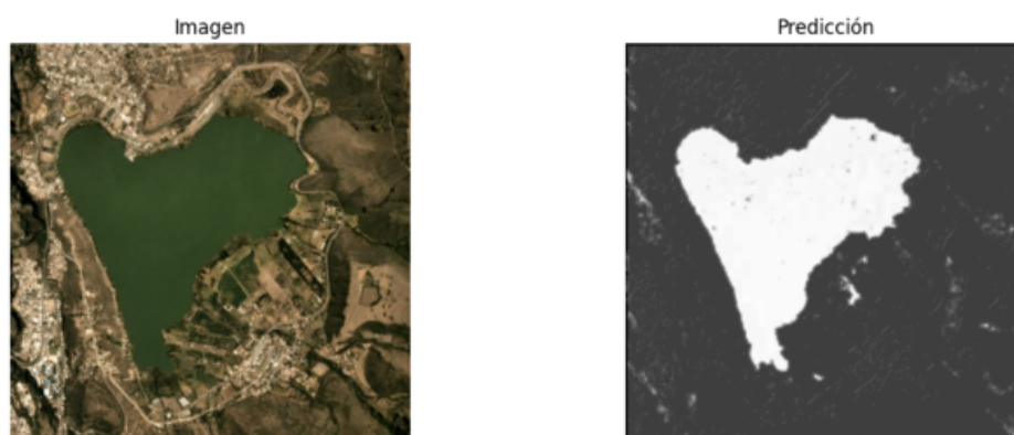
Figura 3.7: Falla del Modelo 3: Inestabilidad en el entrenamiento por limitaciones de hardware.
