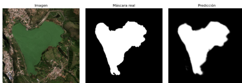
Figura 3.5: Prueba de concepto Modelo 1: Segmentación difusa debido a la pérdida de resolución espacial.
