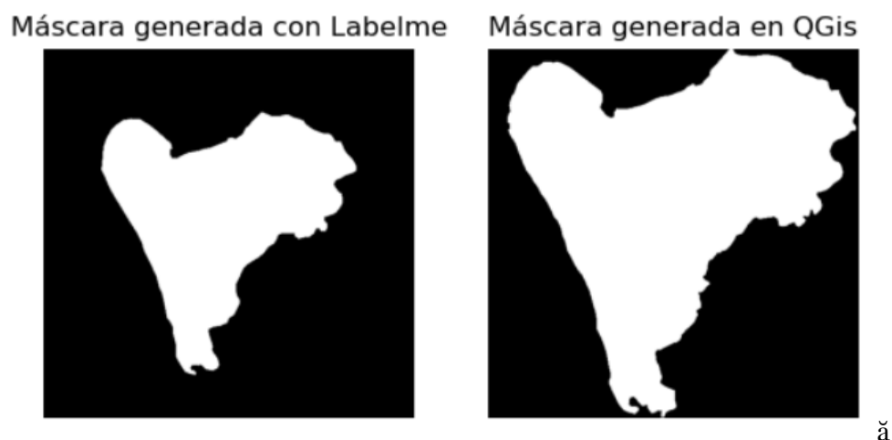
Figura 3.6: Prueba de concepto Modelo 2: Mejora significativa en bordes al mantener resolución original.
