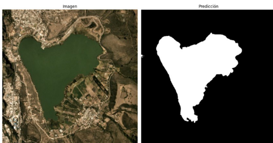
Figura 3.8: Validación del Modelo 4 (Final): Segmentación precisa mediante estrategia de Tiling.
