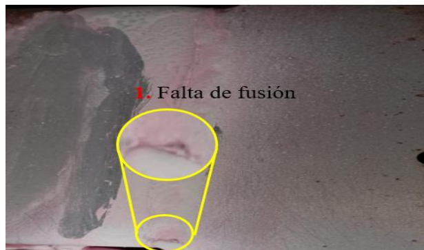
Figura 42. Falla en el larguero Toyota Hilux.
