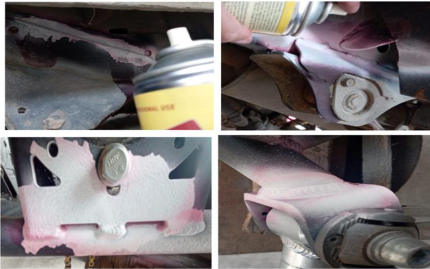
Figura 31. Aplicación de líquido revelador en chasis.
