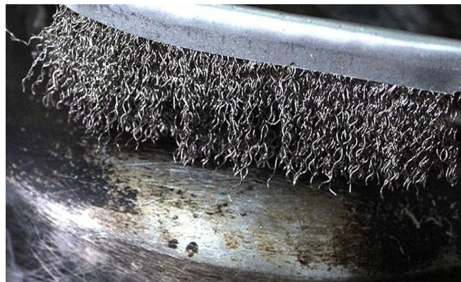
Figura 18. Limpieza manual con cepillo de cerdas metálicas
