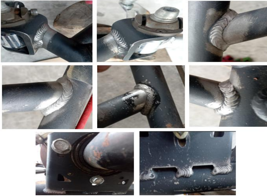
Figura 27. Cordones de soldadura de uniones de Go Kart.
