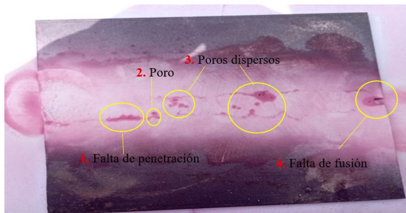
Figura 33. Análisis de ensayos Probeta N°2 SMAW.
