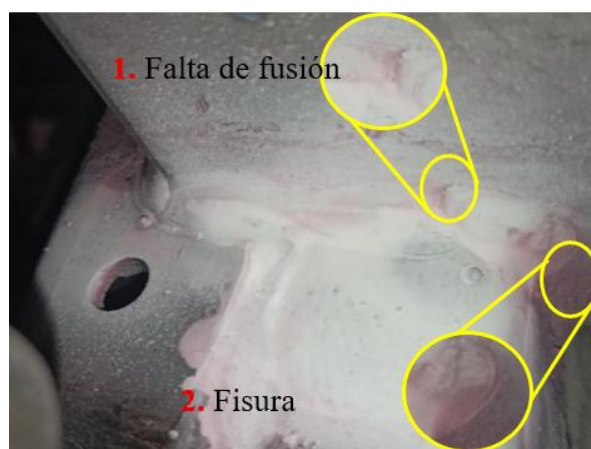
Figura 41. Discontinuidades en el soporte de suspensión delantera Toyota Hilux.
