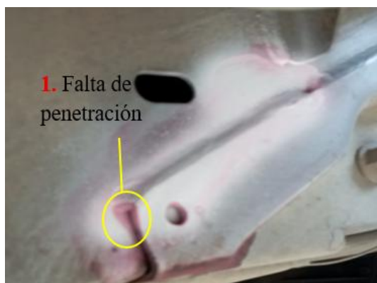
Figura 43. Discontinuidad en el soporte de la suspensión trasera Toyota Hilux.
