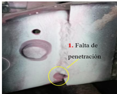
Figura 44. Falla presente en el soporte del motor Nissan Frontier.
