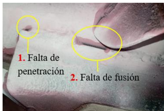
Figura 47. Discontinuidad en el soporte de la suspensión trasera Nissan Frontier.
