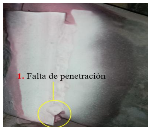
Figura 45. Discontinuidad en el soporte de la suspensión delantera Nissan Frontier.
