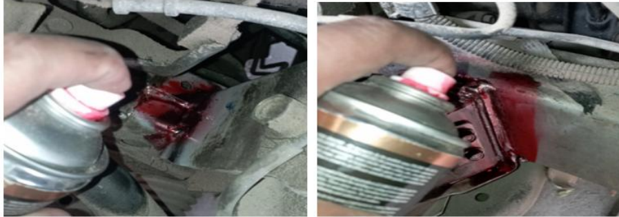
Figura 29. Aplicación de líquido penetrante chasis de vehículos.
