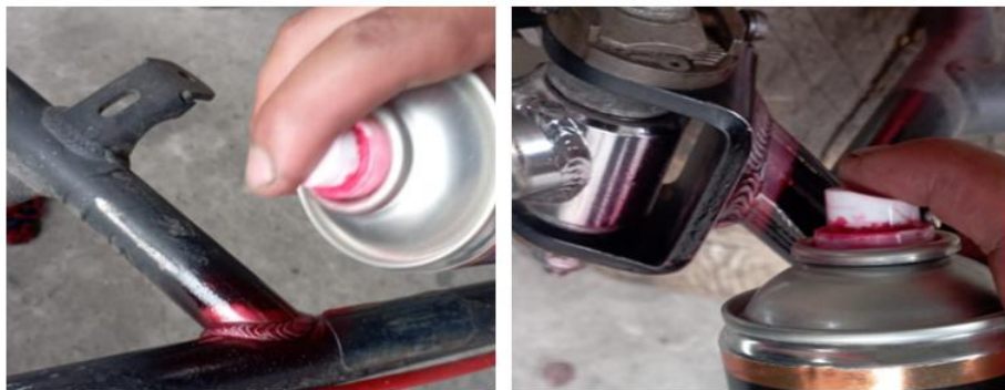
Figura 30. Aplicación de líquido penetrante en chasis Go Kart.
