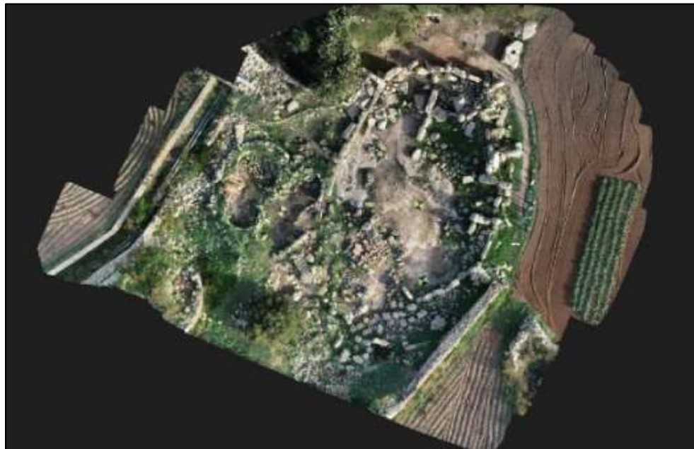
Figura 10. Modelo tridimensional generado por fotogrametría aérea
