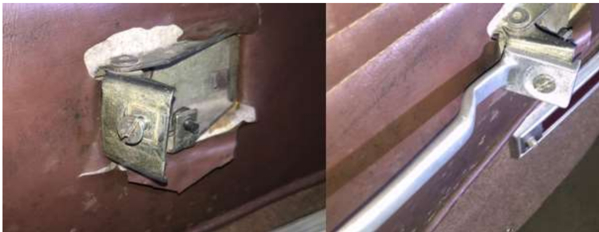
Figura 89. Validación dimensional y funcional, elevador de vidrios
