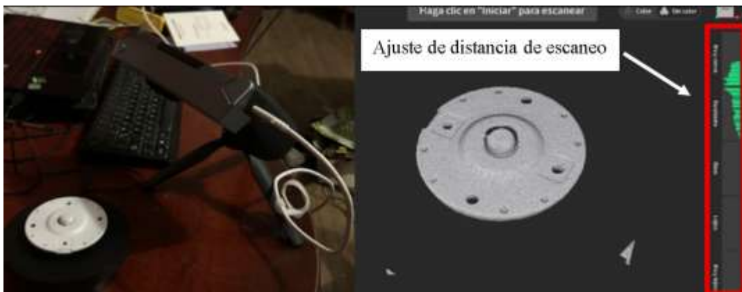
Figura 39. Interfaz para el ajuste de distancia de escaneo
