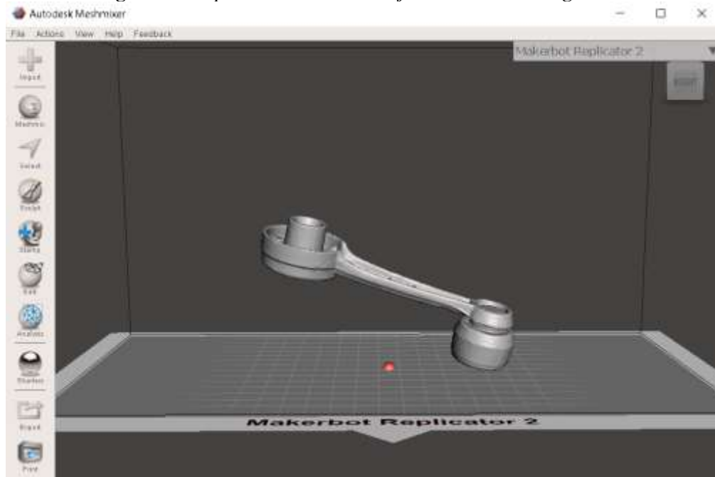
Figura 34. Representación de un objeto en mallas triangulares.
