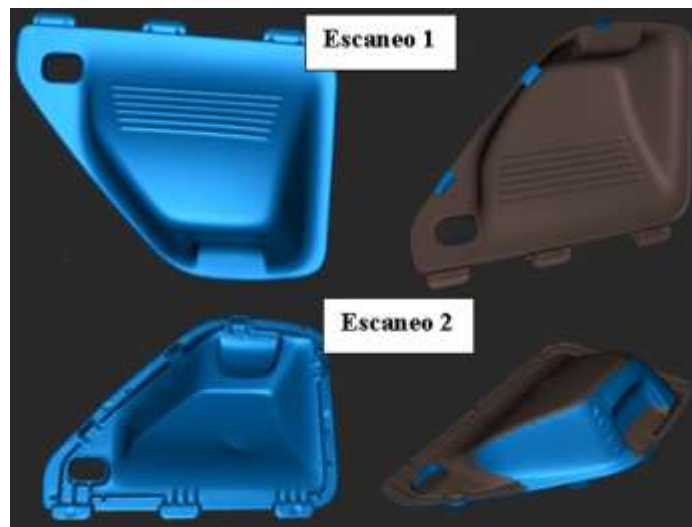
Figura 75. Numero de escaneos, carcasa tanque de agua.
