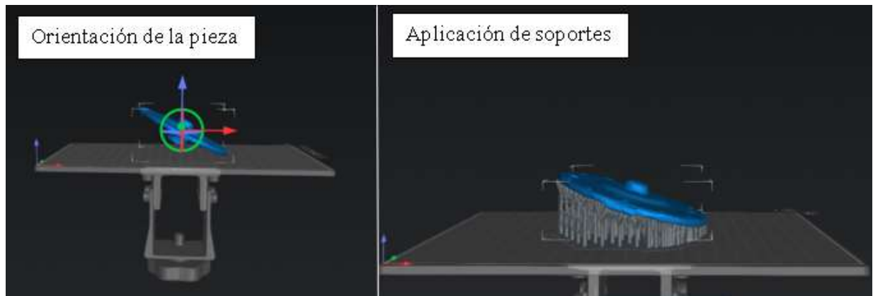
Figura 53. Procesamiento del modelo digital mediante Chitubox.
