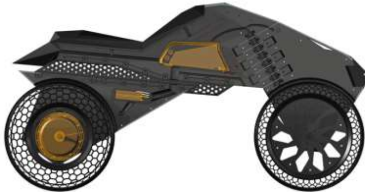
Figura 23. NERA, la motocicleta impresa mediante tecnología FDM
