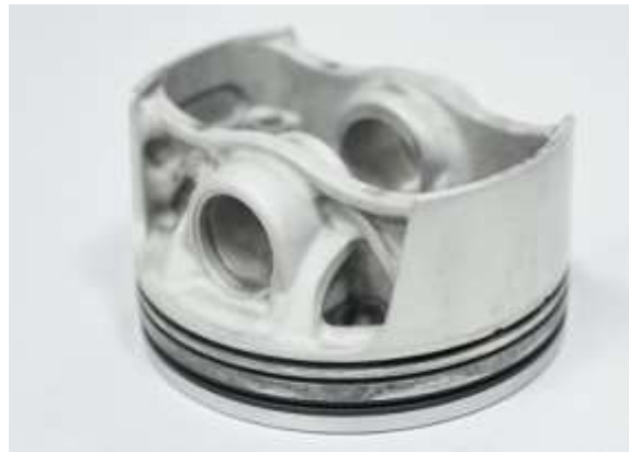
Figura 22. Pistón fabricado a partir de tecnología SLS- Porsche 911 GT2 RS
