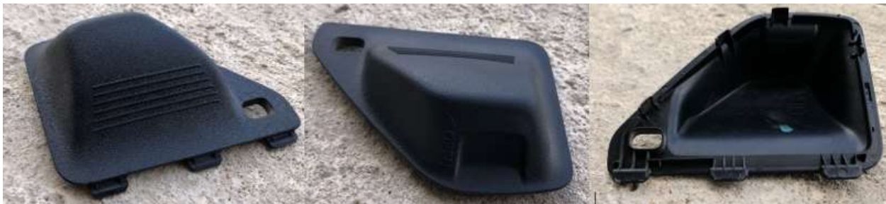
Figura 74. Carcasa del tanque de agua, Ford LTD wagon 1975
