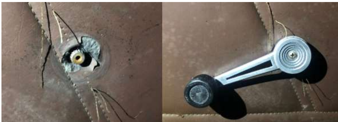
Figura 89. Validación dimensional y funcional, elevador de vidrios
