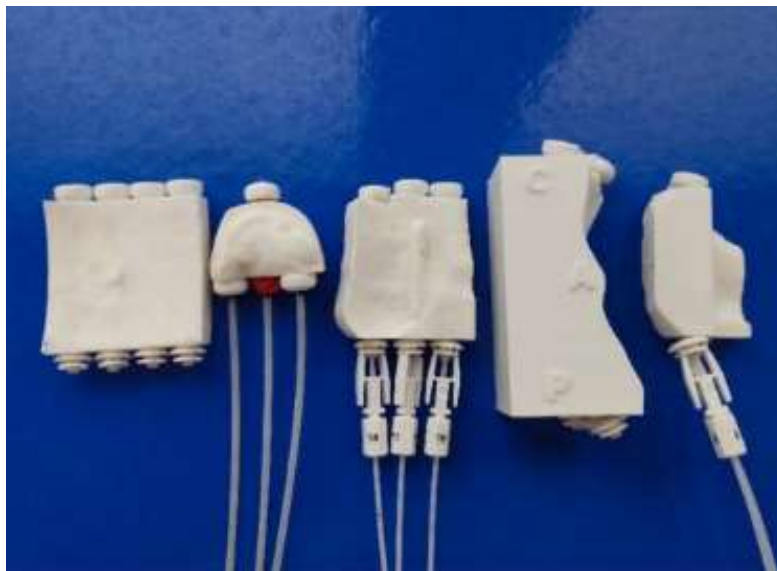
Figura 9. Aplicadores de plesioterapia fabricados a partir de tecnología FDM
