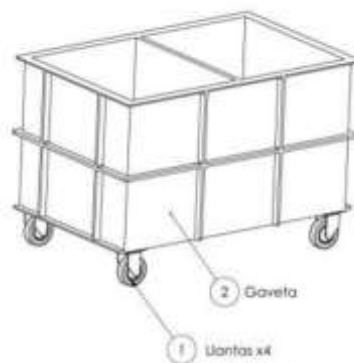
Fig. 27 Diseño de carritos transportadores que se propone para patinador y colocación de capuchón
