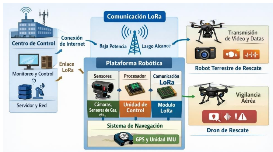
Figura 2.11: Sistema robótico con comunicación LoRa para monitoreo en entornos de rescate [3]
