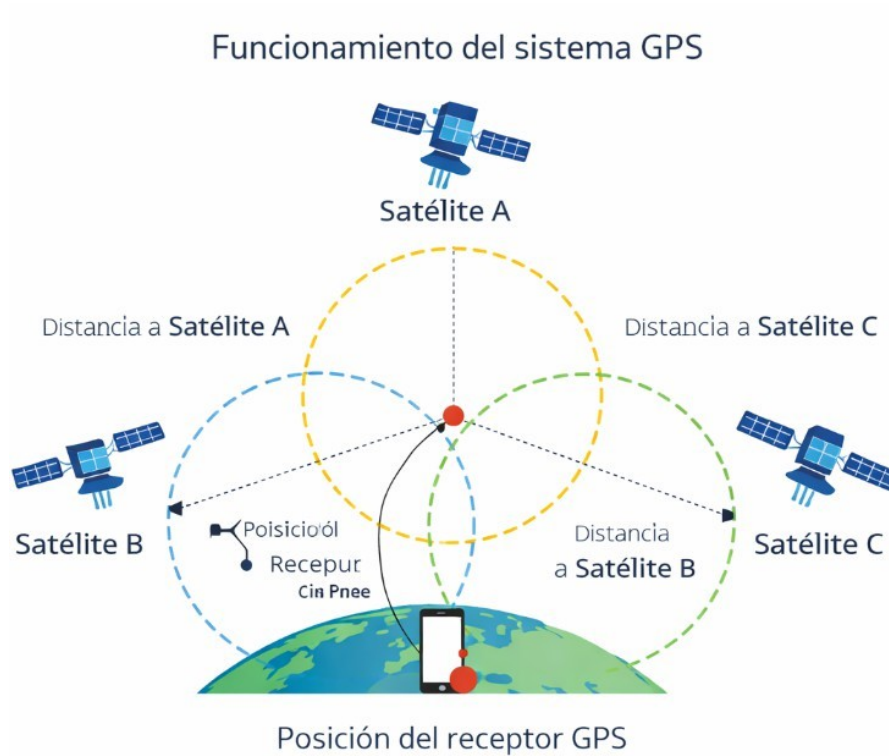
Figura 2.7: Funcionamiento del sistema GPS mediante trilateración satelital
