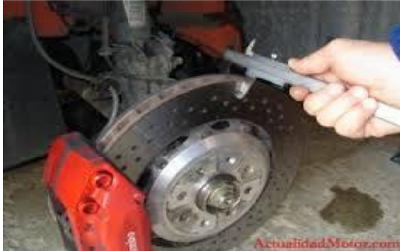
**GRÁFICO 26** REVISIÓN DEL ESPESOR DEL DISCO Y PASTILLAS.
