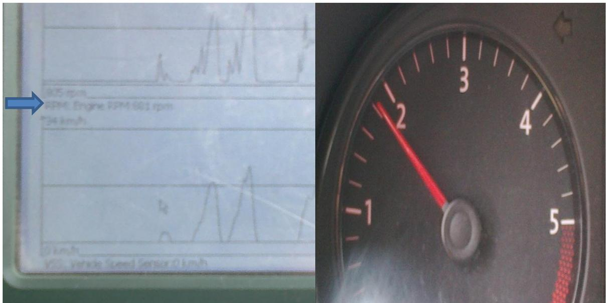
**GRÁFICO 45** FORMA DE ONDA DEL SENSOR DE RPM
