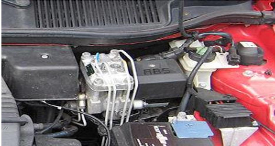
**GRÁFICO 1** Bomba de freno y calculador electrónico abs.
