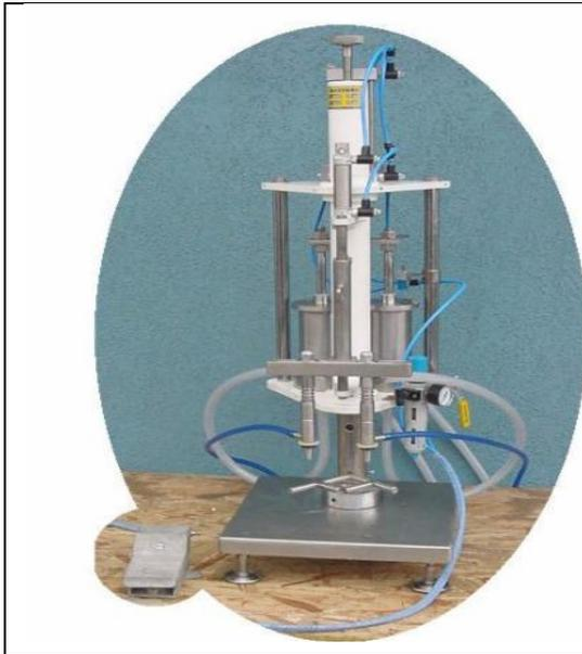
Máquina dosificadora para productos líquidos de alta y baja viscosidad, de doble cilindro de succión e inyección de accionamiento neumático para llenado simultáneo de dos envases por activación.
