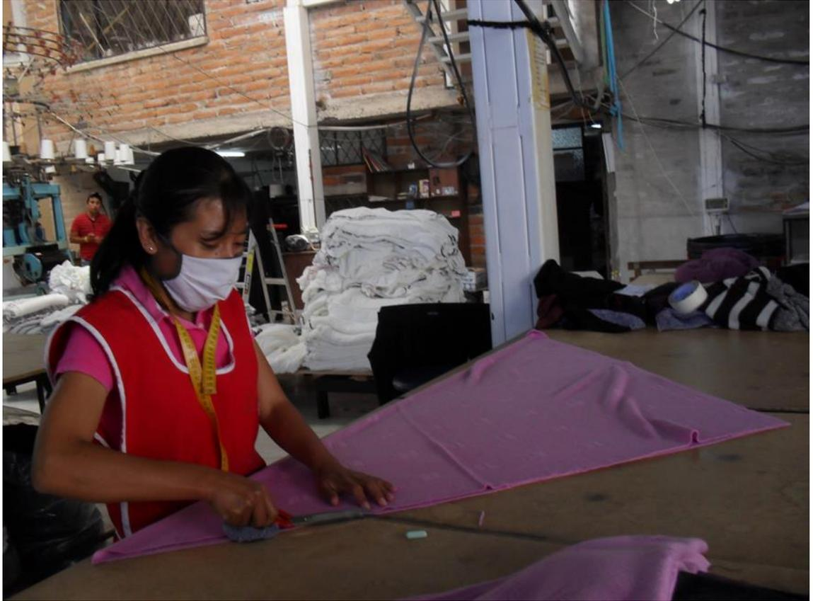
Las piezas planchadas se cortan según medidas indicadas sea con tijera o utilizando cortadora de acuerdo a los moldes
