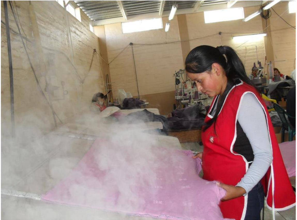
Aquí se vaporiza las piezas tejidas para poder cortar según orden de producción y moldes
